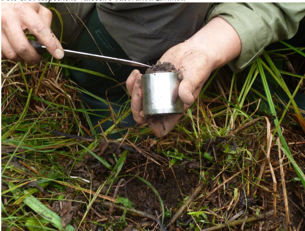
Foto č. 5: Kopeckého váleček s odebranou zeminou
