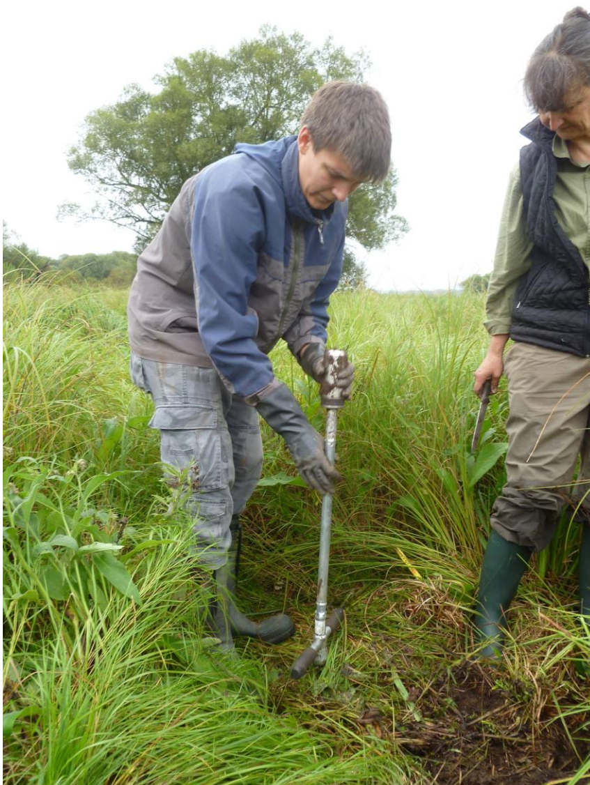
Obrázek č. 6: Odběr zeminy půdní sondou.
