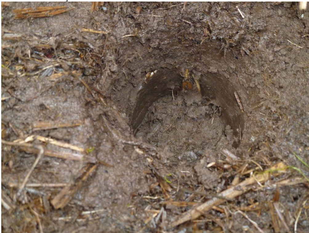
Foto č. 5: Kopeckého váleček s odebranou zeminou
