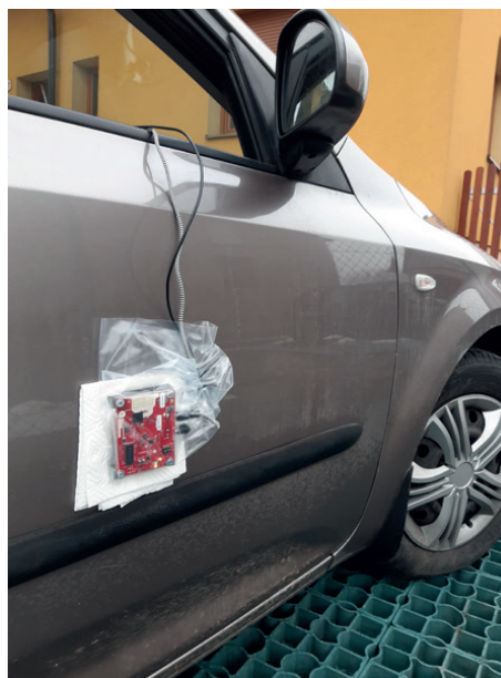
Obrázek 4.4: Umístění radaru při prvním sběru dat.
