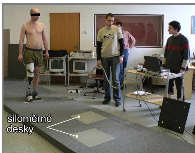
Obr. 5.4 Dráha s umístěním siloměrných desek
