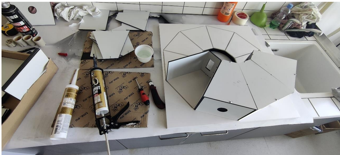
Obr. 28. Proces lepení komor
