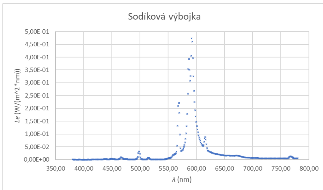
Obr. 11. Světelné spektrum nízkotlaké sodíkové výbojky
