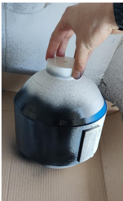
Obr. 29. Nanášení barvy na kulový integrátor
