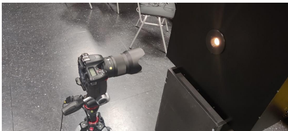
Obr. 39. Měření jasovým analyzátořem
