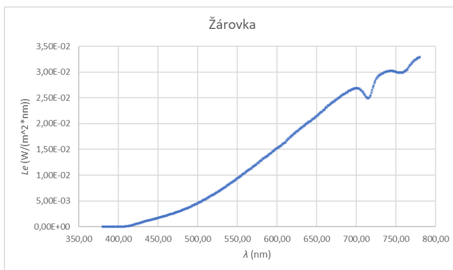
Obr. 8. Poměrné spektrální složení světla žárovky [5]
