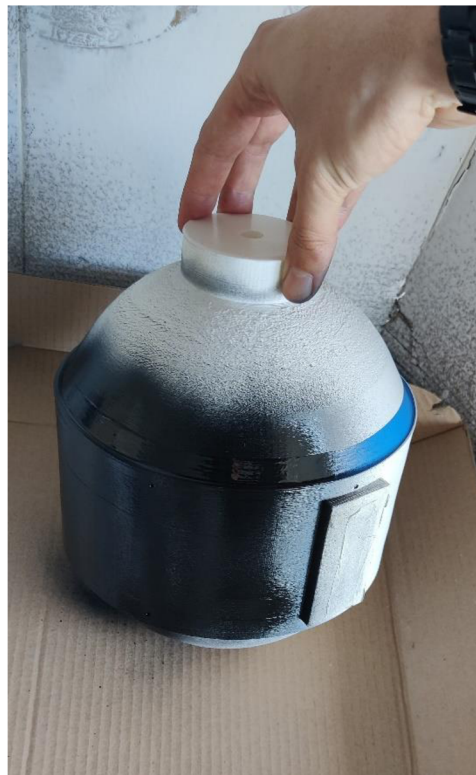
Obr. 29. Nanášení barvy na kulový integrátor
