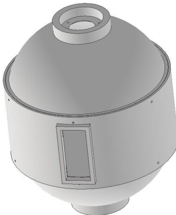
Obr. 23. 3D model kulového integrátoru
