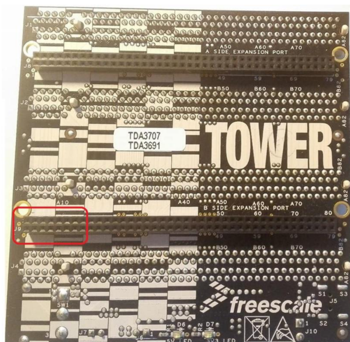
Obr. 7-3 Základní vyvedení signálů modulu TOWER
