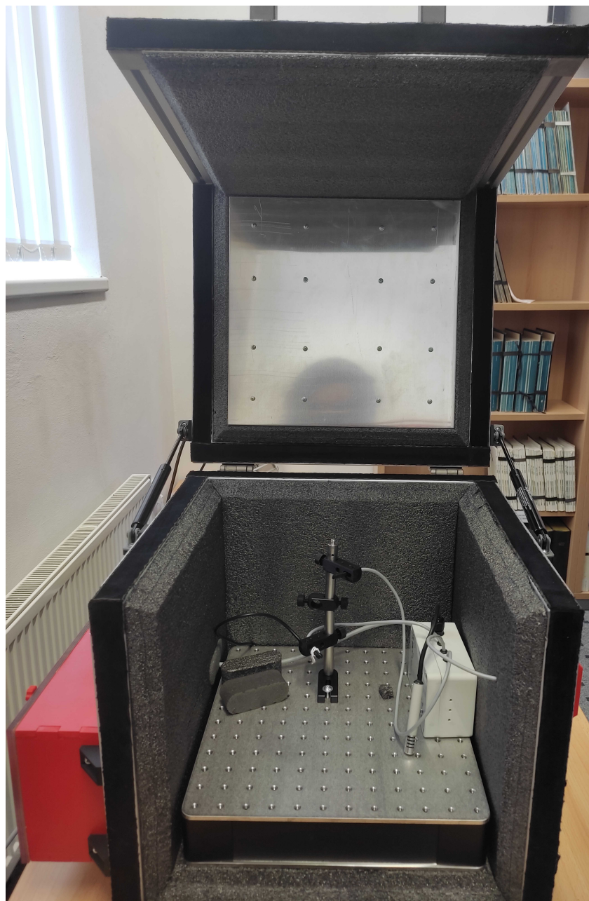
Obr. 6.1: Vnútro teplotnej komory
