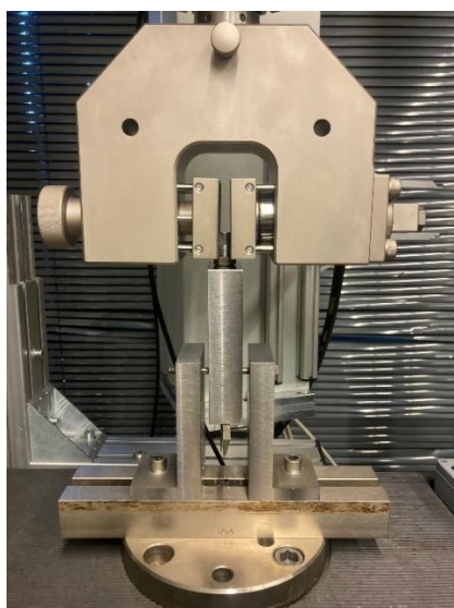
Obr.53 Průběh statické zkoušky při 20 °C
