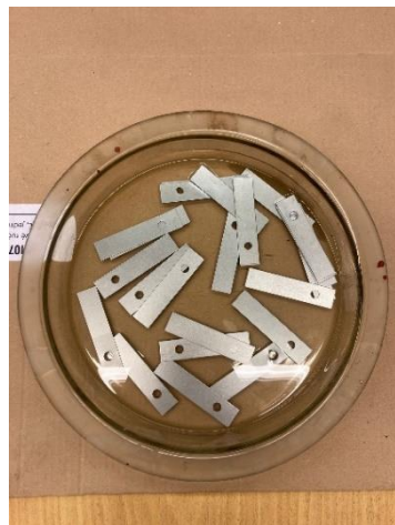
Obr.37 Odmašťování plechových pásek
