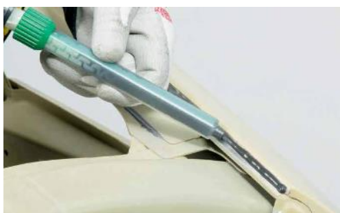
Obr. 8 Aplikace housenky lepidla z kartuše vytlačovací pistolí [15]
