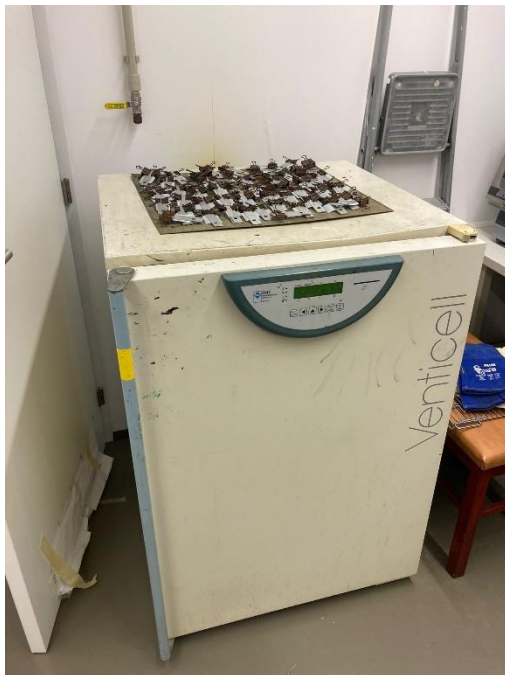
Obr.45 Vytvrzovací komora Venticell 222
