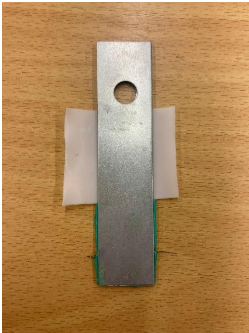
Obr.43 Umístění drátku v lepeném spoji
