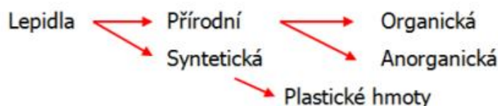
Obr. 5 Základní rozdělení lepidel [7]
