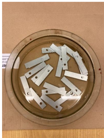
Obr.37 Odmašťování plechových pásek
