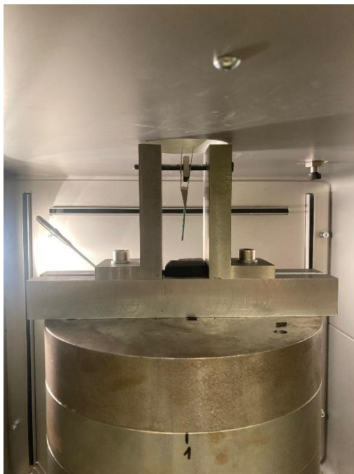
Obr.31 Zkušební přípravek v padostroji
