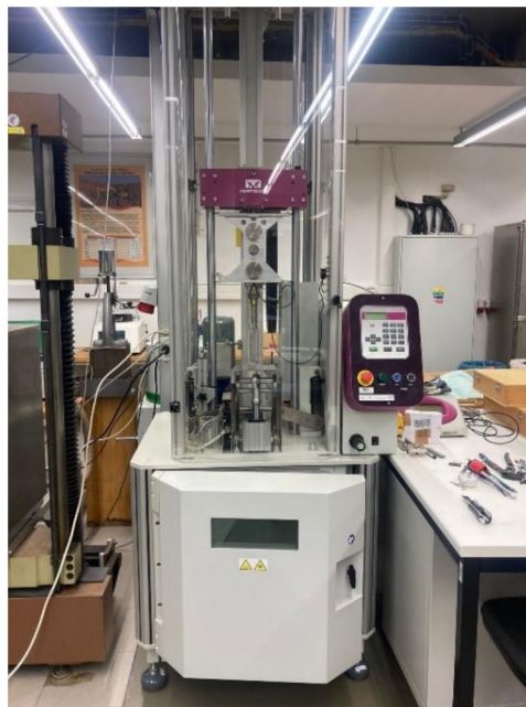
Obr.49 Padostroj Instron Ceast 9350
