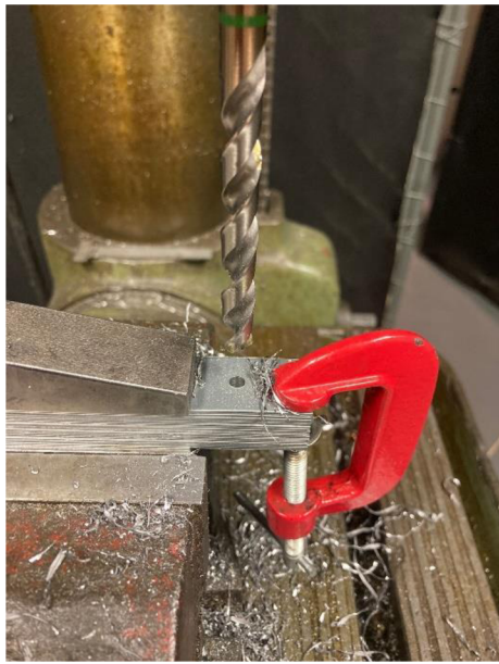
Obr.35 Průběh vrtání uchycovacích otvorů
