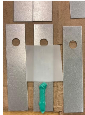
Obr.42 Umístění teflonové folie
