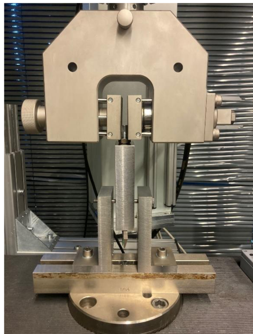
Obr.32 Zkušební přípravek v trhacím stroji
