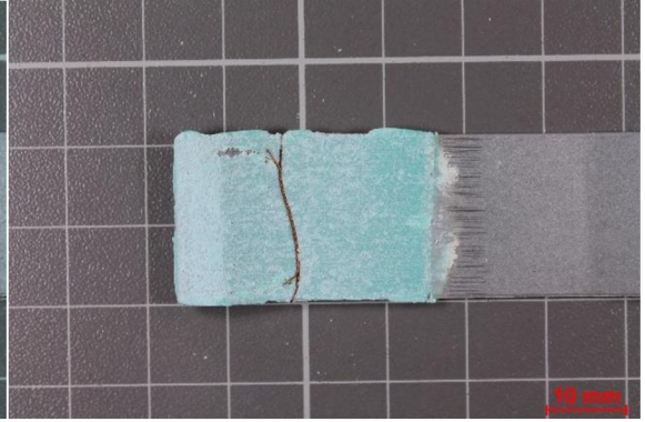
Obr.83 St. zk, 60 °C, vz. , SikaPower®
