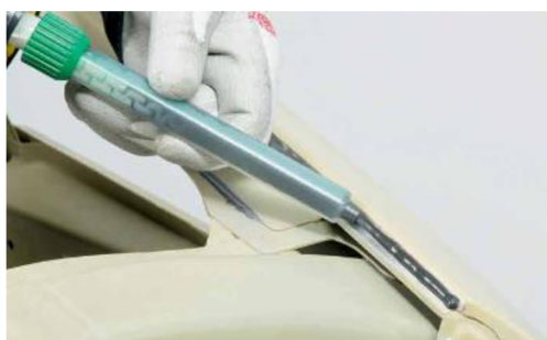
Obr. 8 Aplikace housenky lepidla z kartuše vytlačovací pistolí [15]
