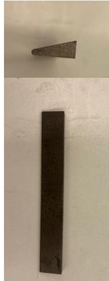
Obr.50 Nesymetrický normalizovaný klín
