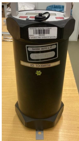
Obr.40 Měření pomocí Infralytic NG2
