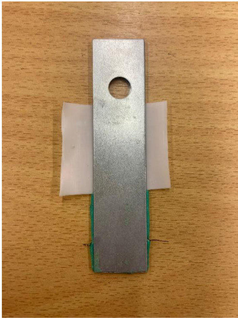
Obr.43 Umístění drátku v lepeném spoji
