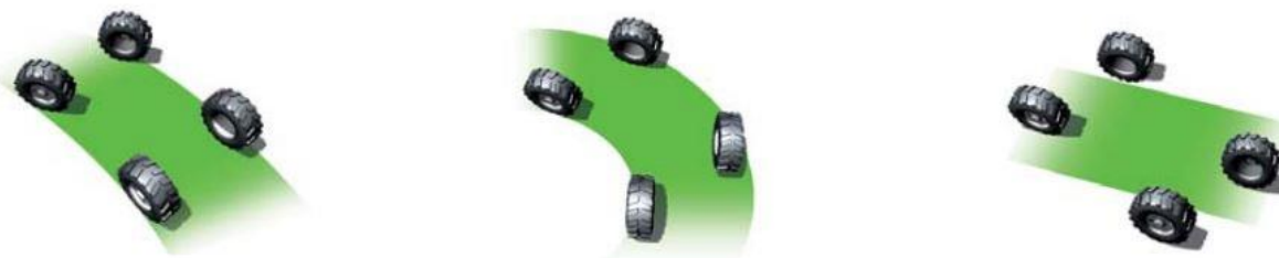
Obr. 5 Možnosti řízení, zleva: řízení jedné nápravy, obou náprav, krabí chod [10]
