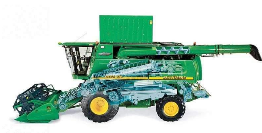
Obrázek 3.5: Schéma jednorotorové axiální mlátičky (John Deere, 2003)
