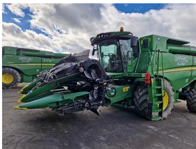
Obrázek 2.8: Složený kukuřičný adaptér Geringhoff
