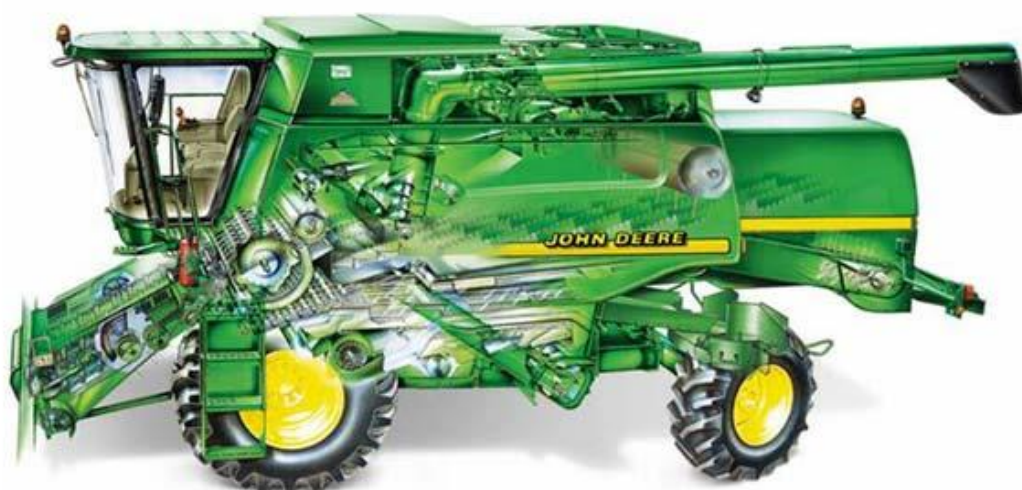
Obrázek 3.2: Schéma tangenciální mlátičky (John Deere, 2002)
