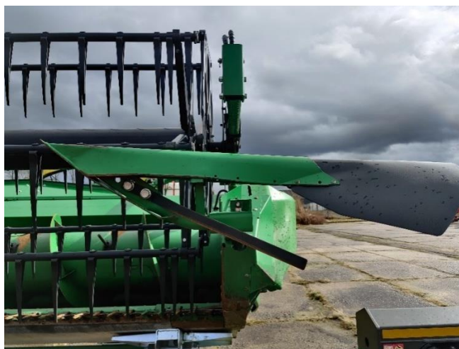
Obrázek 2.3: Pasivní zalamovací dělící
