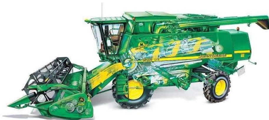
Obrázek 3.8: Schéma hybridní mlátičky JD CTS (John Deere, 2000)
