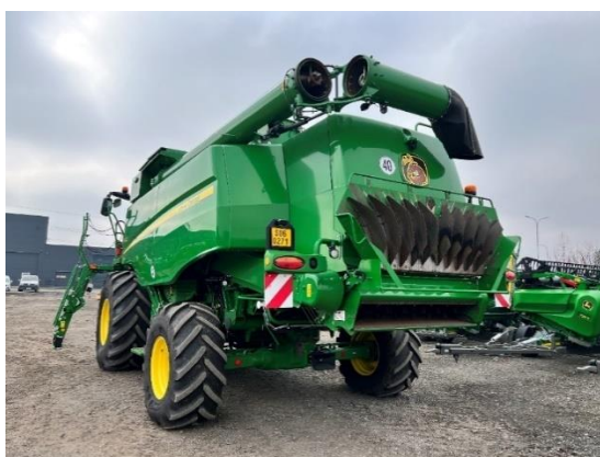
Obrázek 2.14: Zalamovací koncovka výložníku
