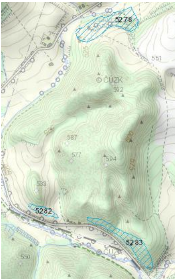
Obr. 109 Svahové deformace Lady (zdroj: Česká geologická služba)
