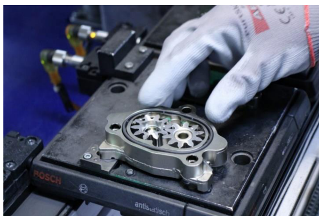
Obrázek 19: Zubové čerpadlo GP40
