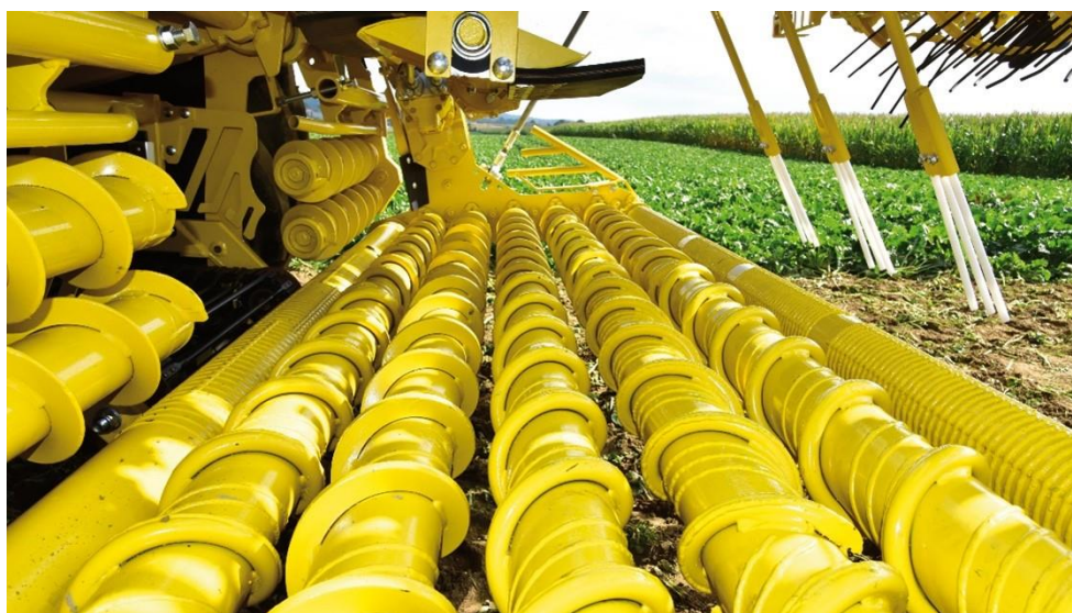
Obrázek č. 9: Fotografie čisticích válců se šroubovicí (10)
