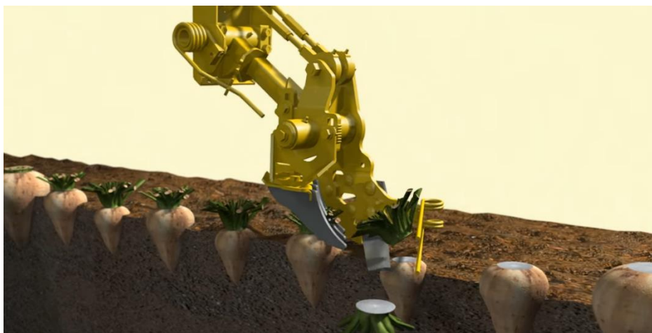
Obrázek č. 6: Schéma práce microtopperu (10)
