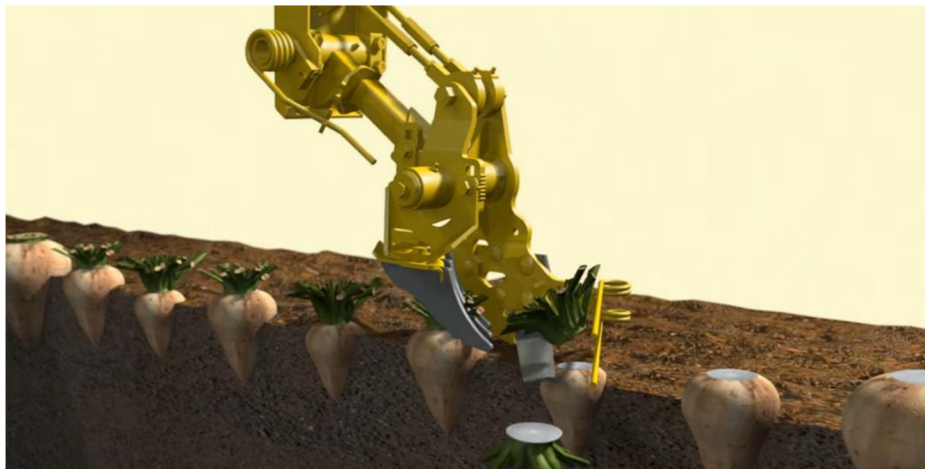
Obrázek č. 6: Schéma práce microtopperu (10)
