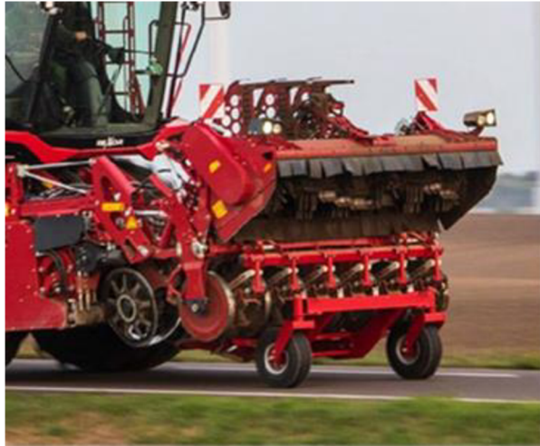
Obrázek č. 21: Fotografie využití dvou kol při přepravě stroje po silnici (15)
