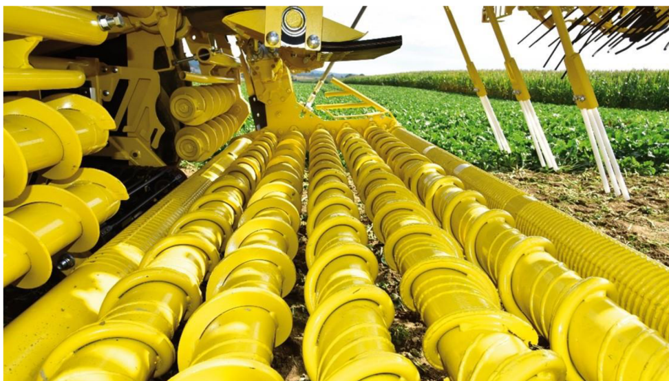
Obrázek č. 9: Fotografie čisticích válců se šroubovicí (10)
