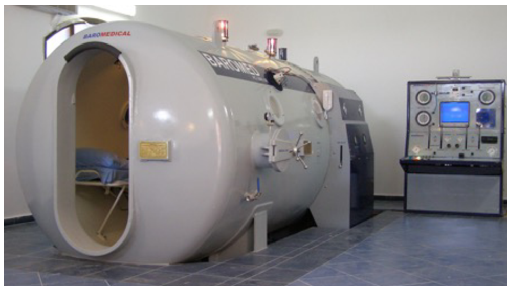
Obrázek 29: Barokomora v centru Red Sea Diving Safari Zdroj: Red Sea Diving Safari (2023)
