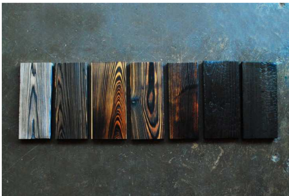
Obrázek 14 - Možné odstíny při povrchovém ošetření dřeva ohněm (zdroj: www.remodelista.com )
