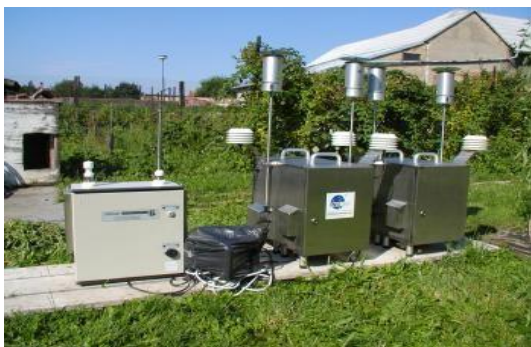
Obr.14 Kompletní sestava pro měření prachových částic – Ambulantní měření čistoty ovzduší v Jihomoravském kraji, ČHMÚ, pobočka Brno Envitech Bohemia s.r.o., Centrum dopravního výzkumu, ZÚ se sídlem v Brně
