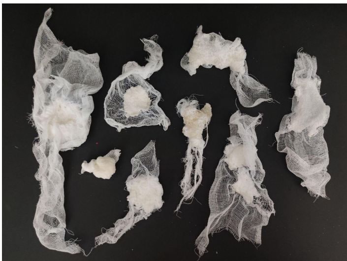
Obr. č. 27 Skúšky superželé hmoty v kombinácii s gázou
