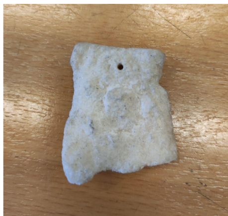
Obr. č. 26 Skúška rezania, pilovania, vrtania a preškrabávania superželé hmoty
