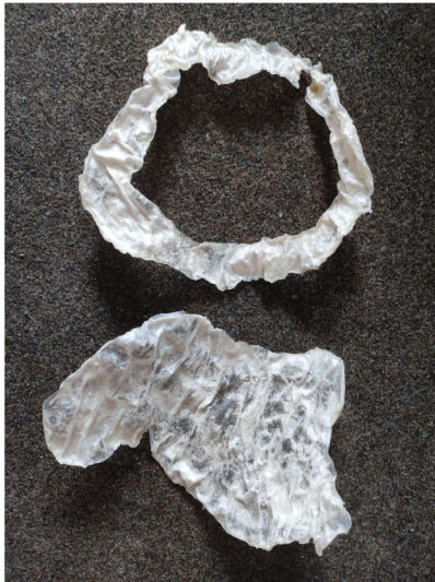
Obr. č. 32 Skúšky superželé hmoty v kombinácii s pauzovacím papierom
