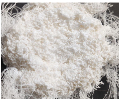
Obr. č. 28 Štruktúra spôsobená zmrštením superželé hmoty
