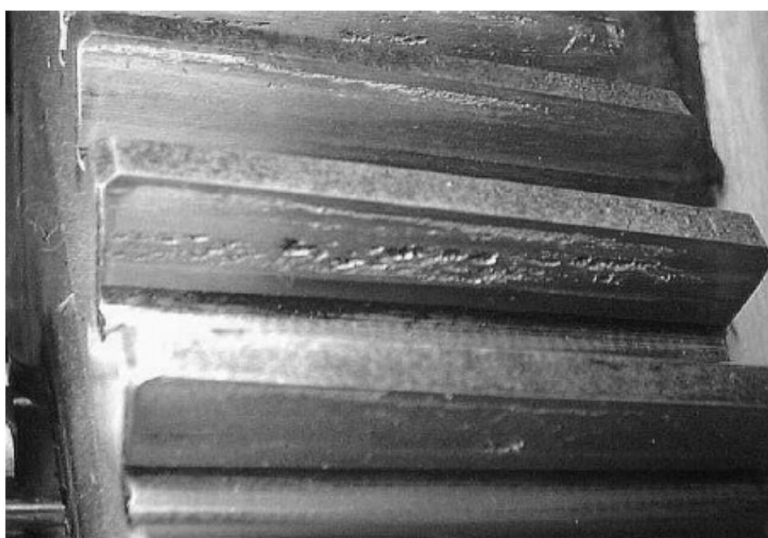
Obrázek 18: Opotřebená ozubená kola způsobená kontaktní únavou [35]
