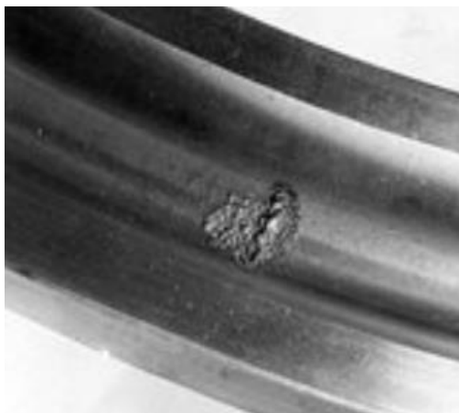
Obrázek 20: Mezní stav únavového opotřebení vnějšího kroužku ložiska [38]
