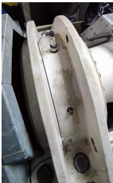
Obrázek 23: Senzory akustické emise zapojené na hlavním ložisku
