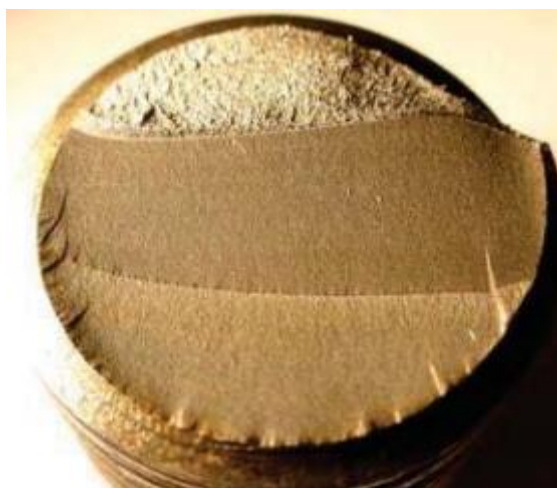
Obrázek 17: Mezní stav únavového lomu hřídele [34]
