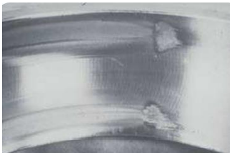
Obrázek 22: Adhezivní opotřebení ložiska [41]
