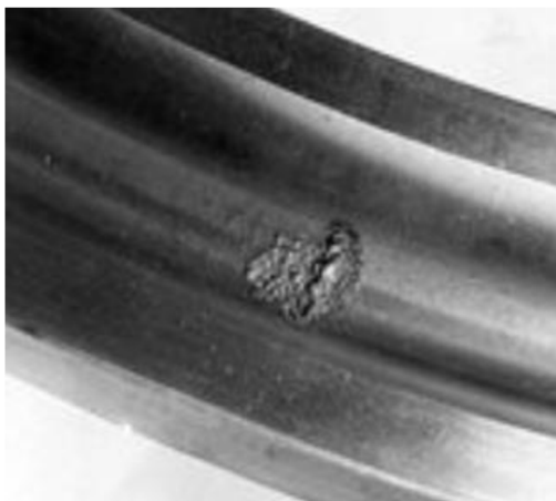
Obrázek 20: Mezní stav únavového opotřebení vnějšího kroužku ložiska [38]
