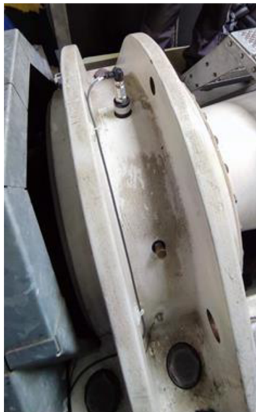
Obrázek 23: Senzory akustické emise zapojené na hlavním ložisku
