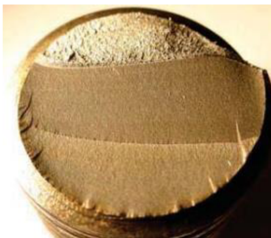
Obrázek 17: Mezní stav únavového lomu hřídele [34]
