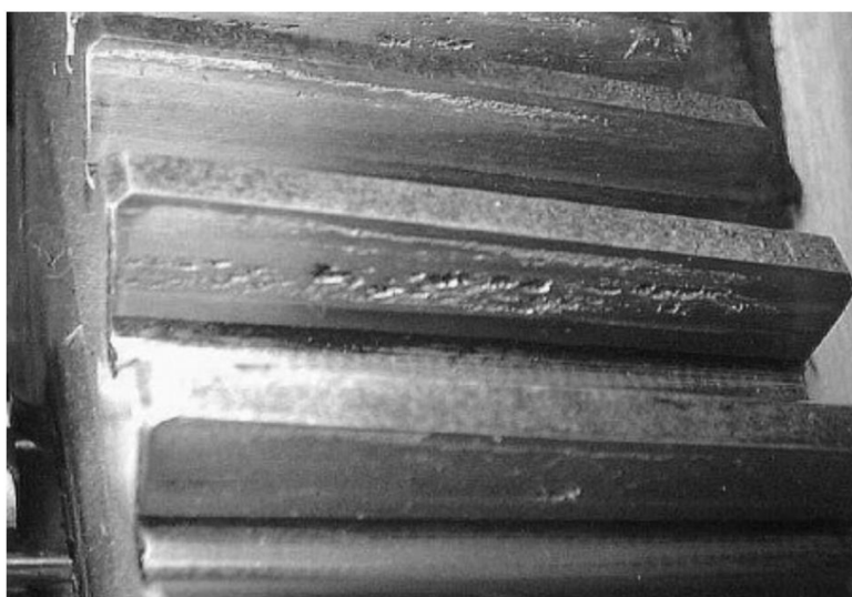
Obrázek 18: Opotřebená ozubená kola způsobená kontaktní únavou [35]
