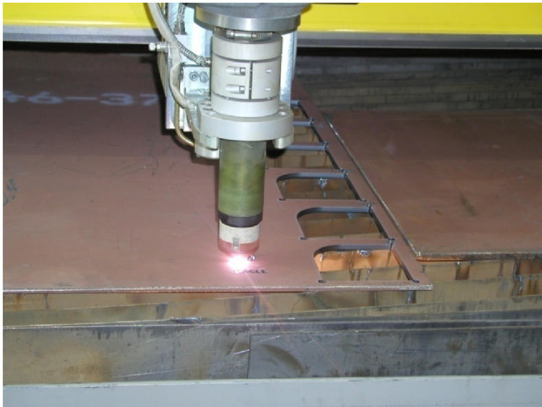
Obr. 6. 5 Řezání přesnou kyslíkovou plazmou[17]
