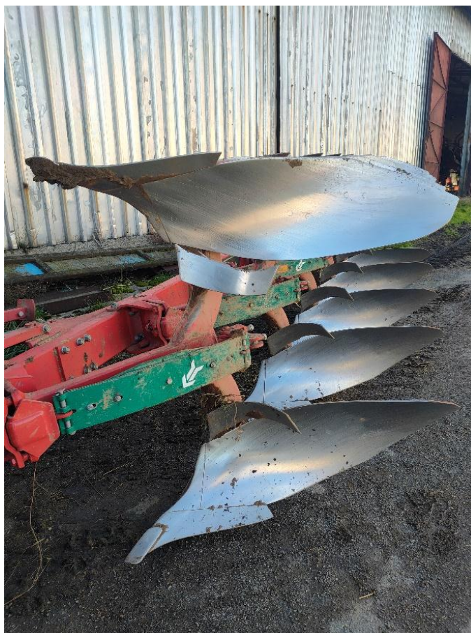
Obrázek 2.3 – Pluh Kverneland (jištění pomocí listových per)
