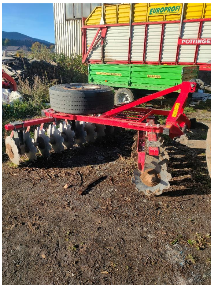
Obrázek 1.2 - Diskový podmítač (záběr 3 m)
