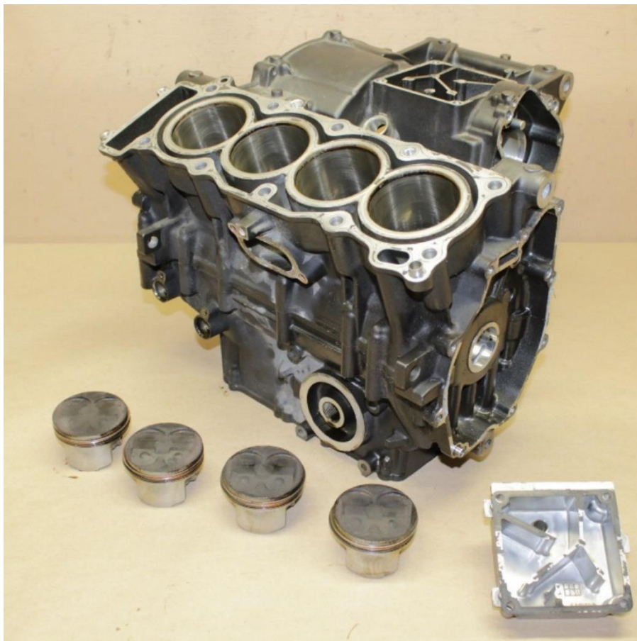
Obrázek 2 - blok válců motoru Yamaha FZ6 spolu s písty [20]
