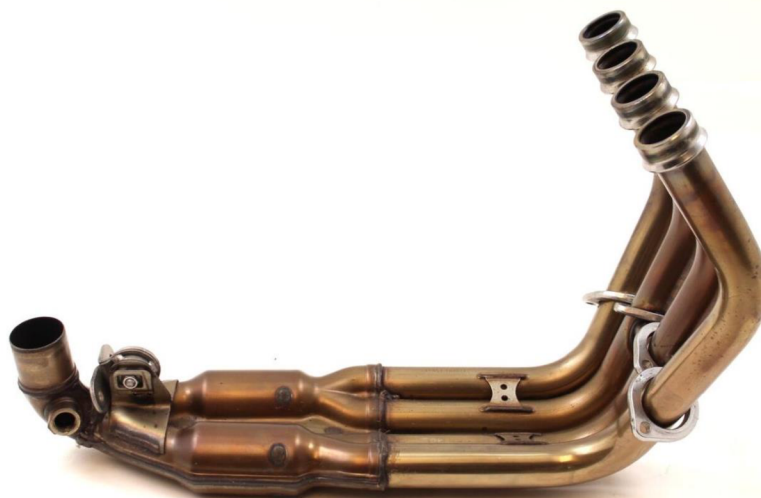
Obrázek 9 - Výfukové svody 4-2-1, Yamaha FZ6 [27]
