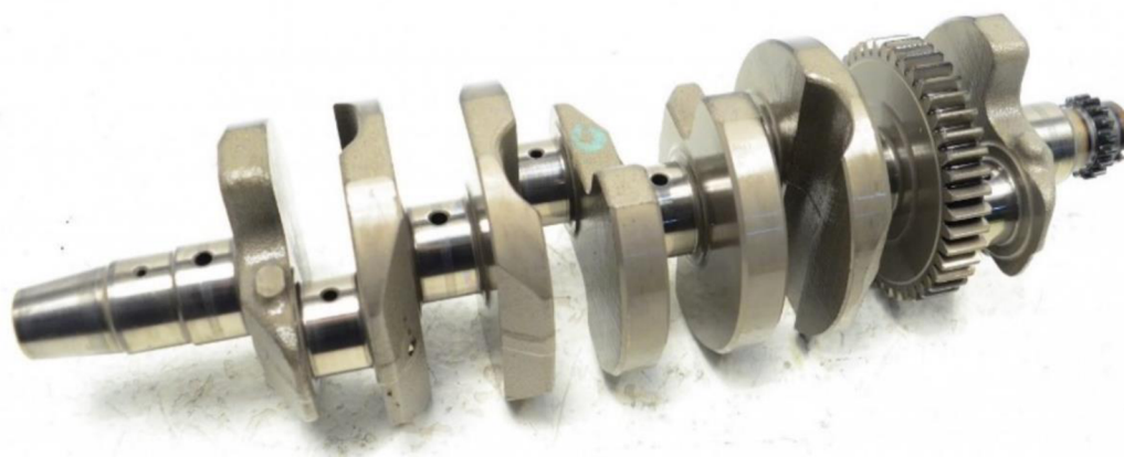
Obrázek 3 - Klikový hřídel Yamaha FZ6 [21]
