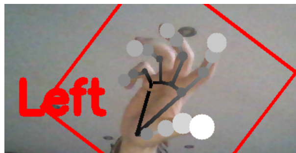
Obr. 2.4: Snímanie ľudskej ruky pomocou MediaPipe Hands
