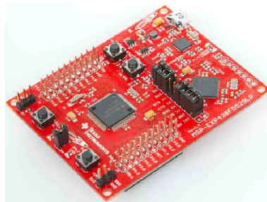
Obr. 4.6: Vývojová sada MSP430F5529 LaunchPad Development Kit[23]
