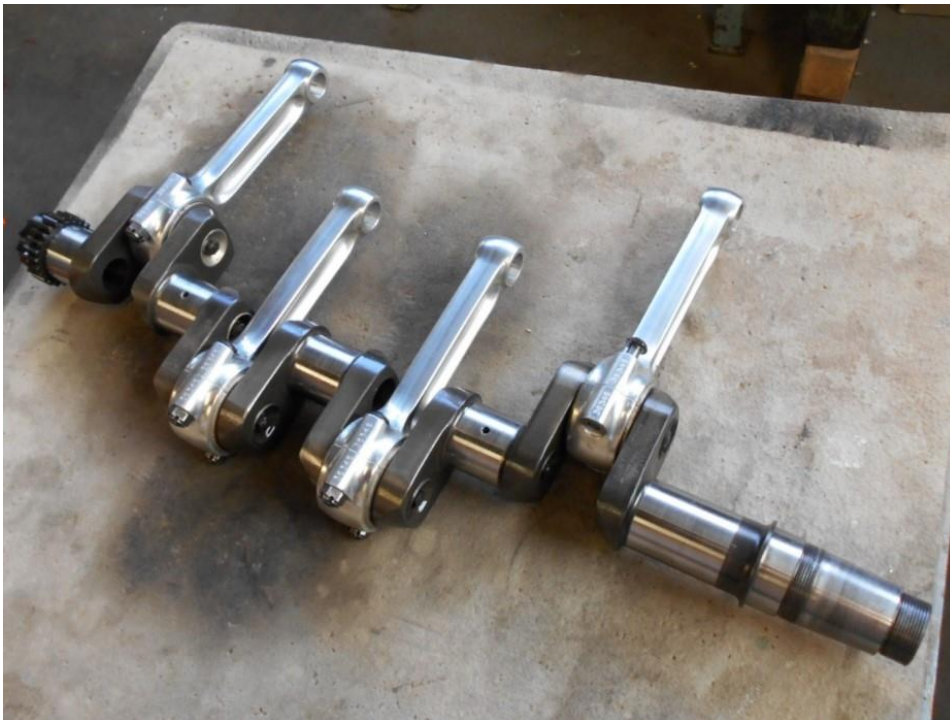
Obr. 30 Část klikového mechanismu Walter Mikron III s původní duralovou ojnici [54]
