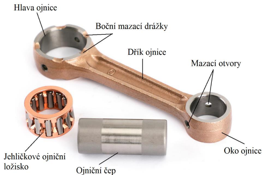
Obr. 15 Ojnice dvoudobého motoru [66]
