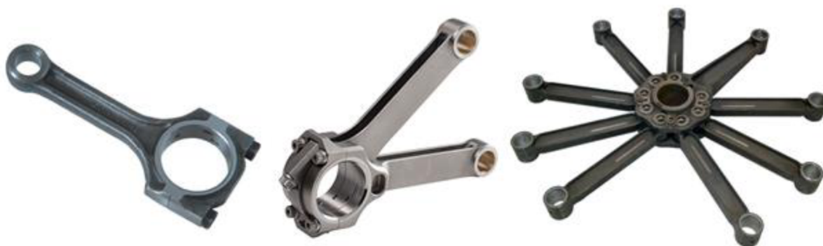
Obr. 14 Typy ojníc, zleva: prostá ojnice [33], rozvidlená ojnice [57], ojnice hlavní a vedlejší [58]
