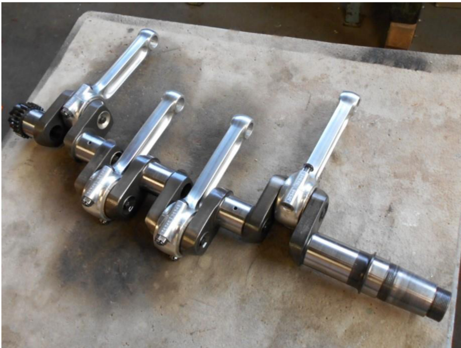
Obr. 30 Část klikového mechanismu Walter Mikron III s původní duralovou ojnicí [54]
