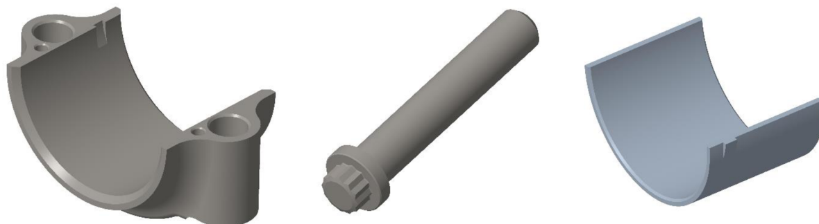
Obr. 32 Detail modelů vika I ojnice, ojničního šroubu a ložiskové pánve
