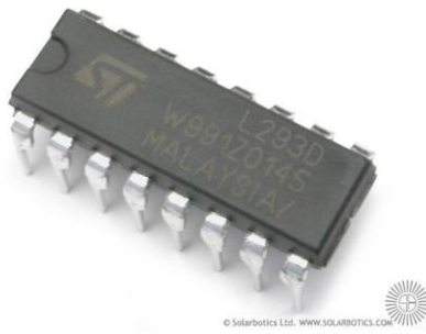
Obrázek 4: Integrovaný obvod L293D
