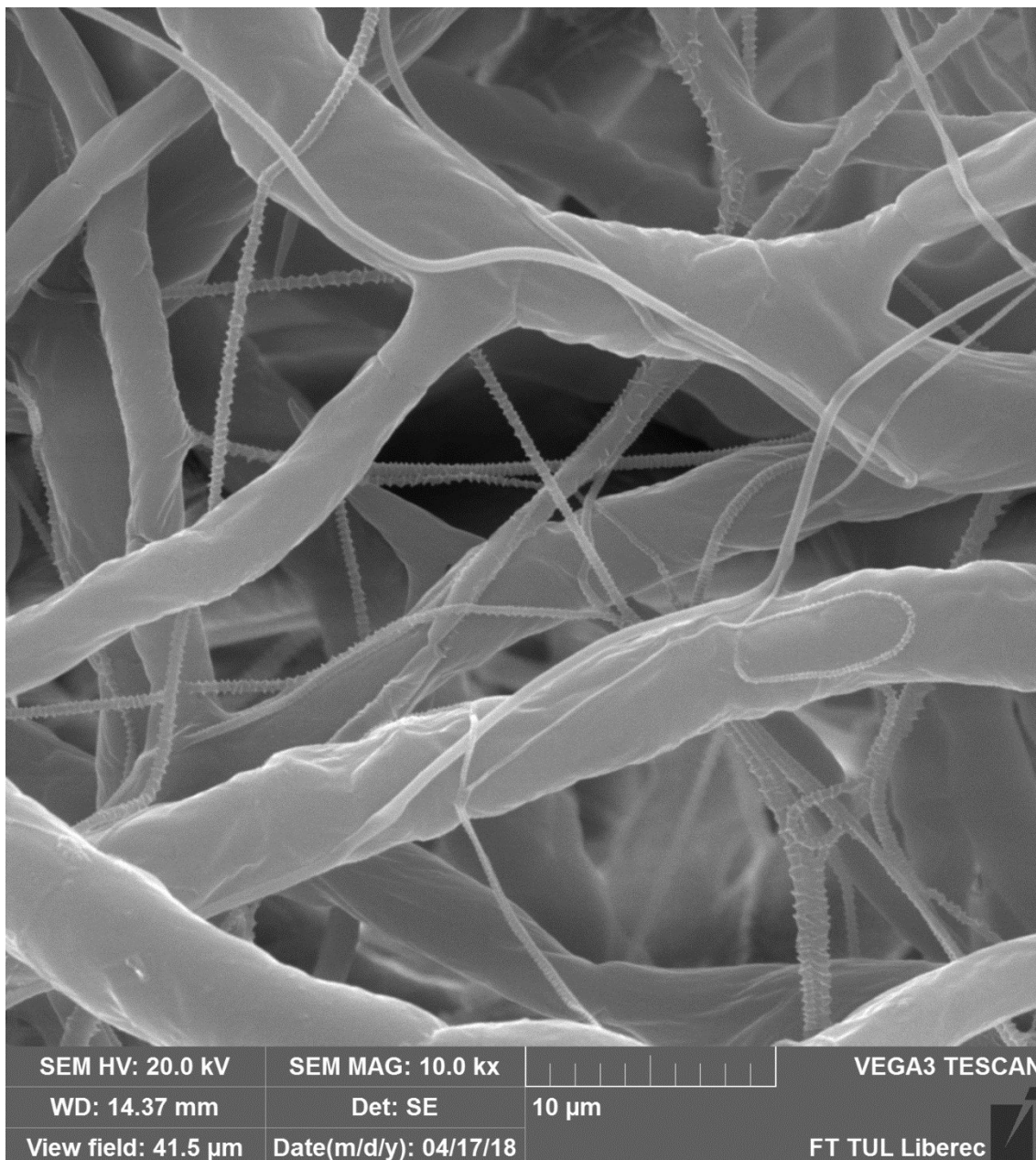
Obrázek 80 SEM snímek pro déle zvlákněvanou vlákennou strukturu z modifikované jehly shora; kolektorová kapalina ethanol; měřítko 10 \mu m; shish-kebab struktura
