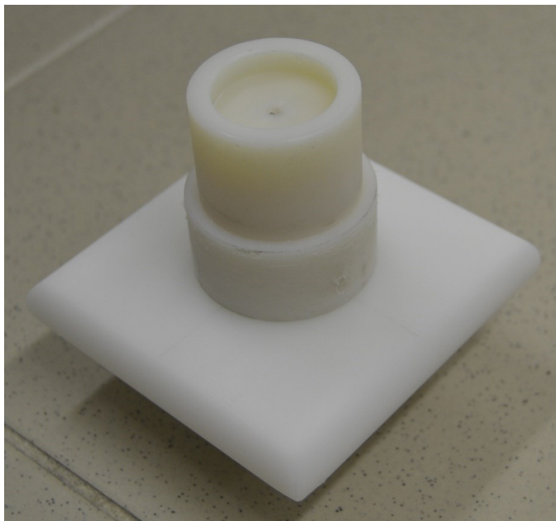
Obrázek 17 PTFE rezervoár s průměrem bazénku 30mm a hloubkou 6,6mm
