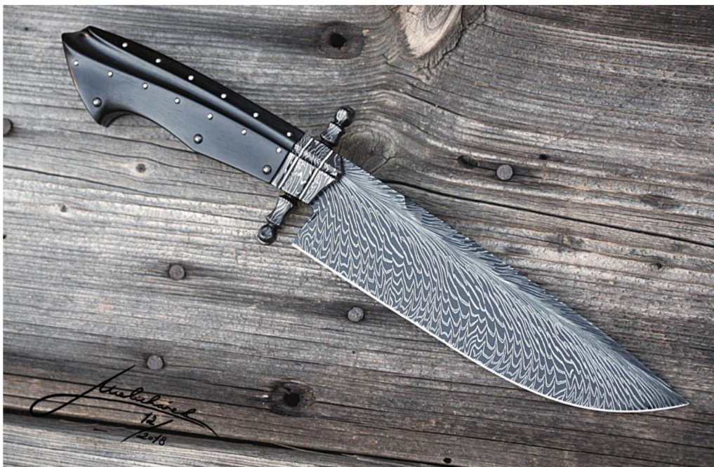
Obr. 2 Nůž ze svářkového damašku, pírkový vzor [10]
