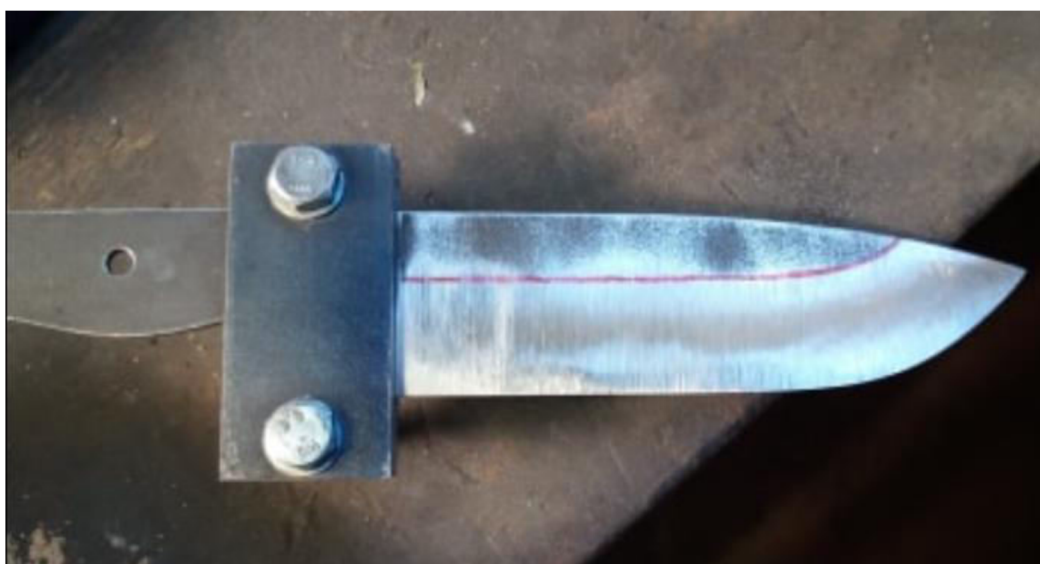
Obr. 29 Dokončený částečný výbrus
