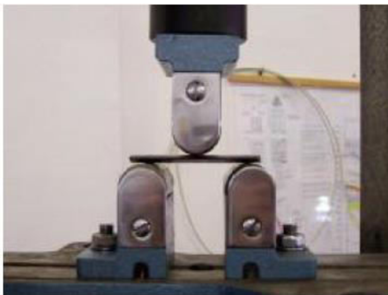
Obr. 13 Zkouška třibodovým ohybem [17]
