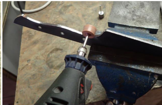
Obr. 25 Dobroušení konečného tvaru
