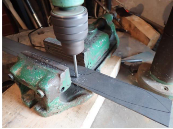
Obr. 23 Odvrtání děr pro piny
