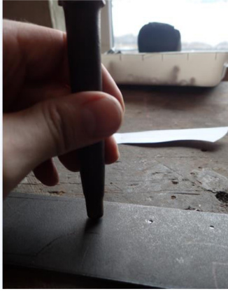
Obr. 22 Naznačení děr dulčíkem
