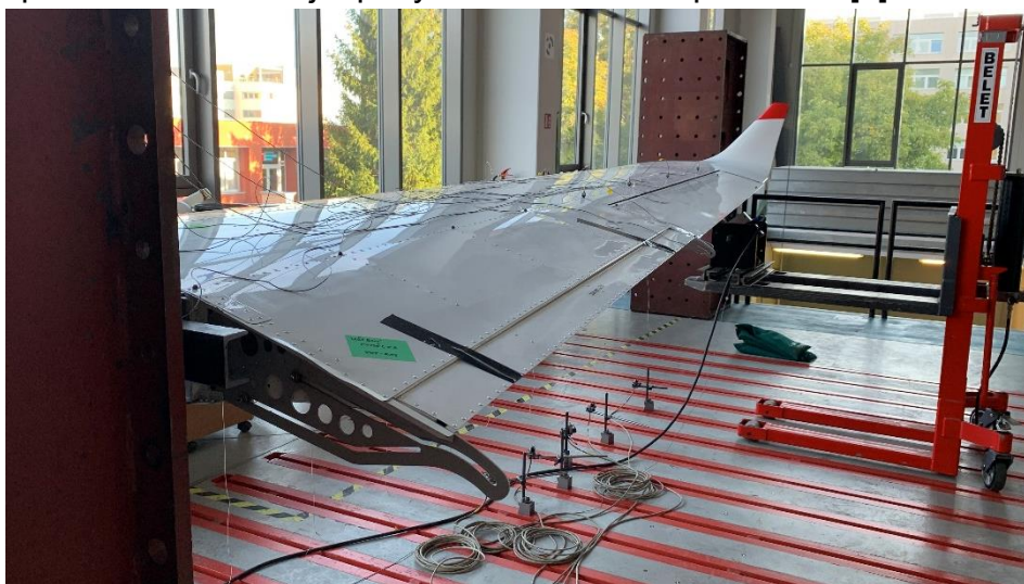
Obr. 5.1 Pozemná frekvenčná skúška krídla lietadla VUT 051 Ray (Foto z archívu autora)
