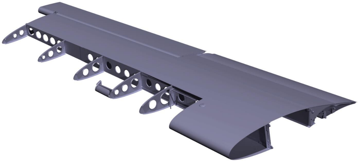
Obr. 4.2 Počiatočný CAD model nosnej plochy VUT 051 Ray
