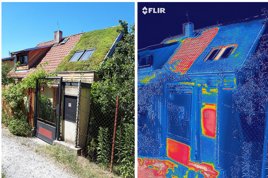
Obrázok 45 Porovnanie strechy s vegetáciou a bez pomocou termosnítku (www.isover.cz, 2022)
