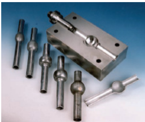
Obr. 1.1 - Díly vyrobené nekonvenčním tvářením [9]
