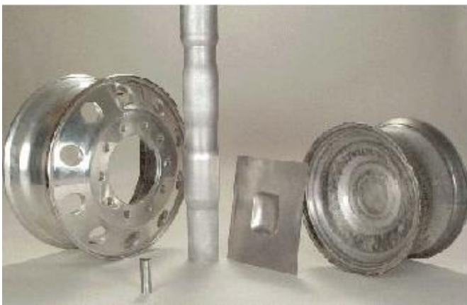
Obr.3.13 Díly vytvořené elektromagnetickým tvářením [9]
