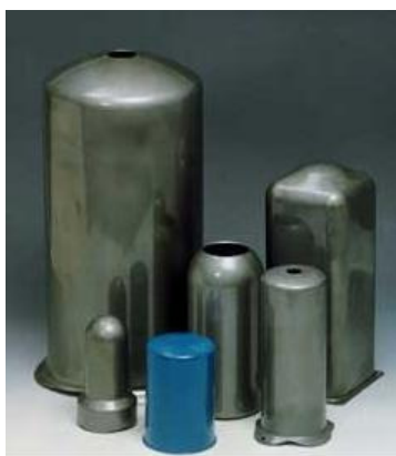
Obr.2.20 Výtažky z lisu ATP [5]
