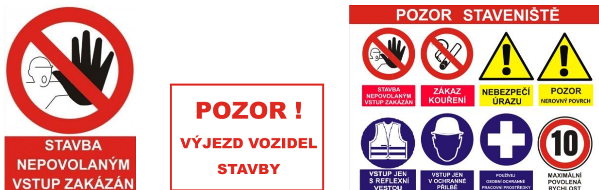
Obr. 1 – Výstražné cedule u vstupu na staveniště
