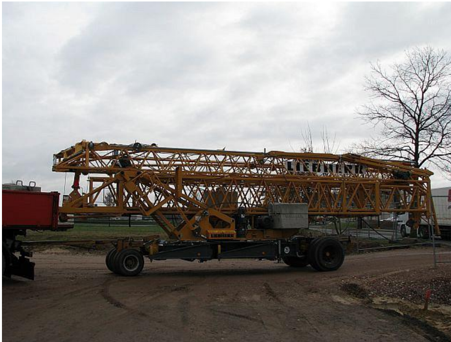
Obr. 26 – Věžový jeřáb 42 K.1 připravený k transportu
