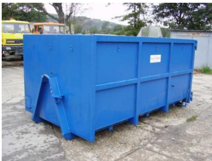
Obr. 7 – Ocelový kontejner na odpad
