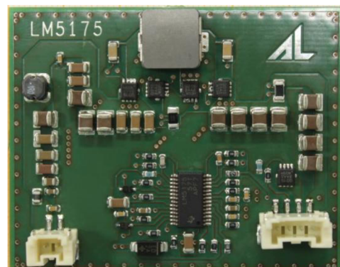
Obr. 42: Vyrobená a osazená DPS
