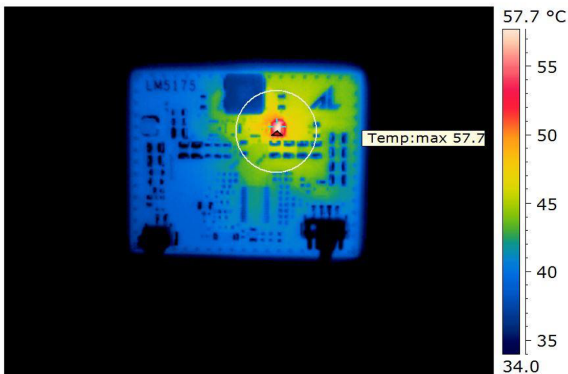
Obr. 62: Snímek z termokamery navrženého obvodu s LM5175
