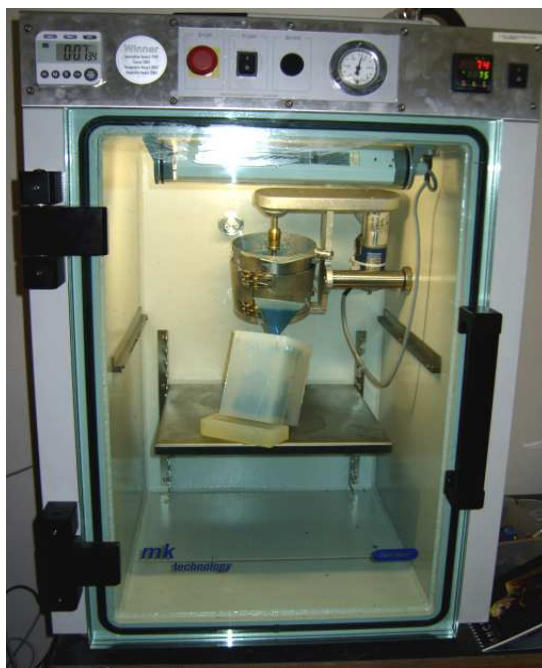
Obr. 2.2-15 Odlévání voskového odlitku ve vakuové komoře
