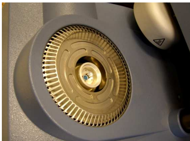
Obr. 2.4-35 Vzorek testované voskové směsi nadávkovaný v komůrce kalorimetru
