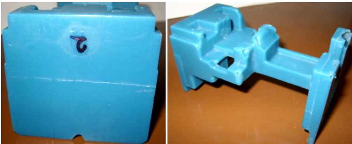
Obr. 2.2-22 Spodní strana modelu č.2 již neobsahuje „pomerančovou kůru,, je třeba ještě odstranit nedolitě místo, levá strana modelu č.2
