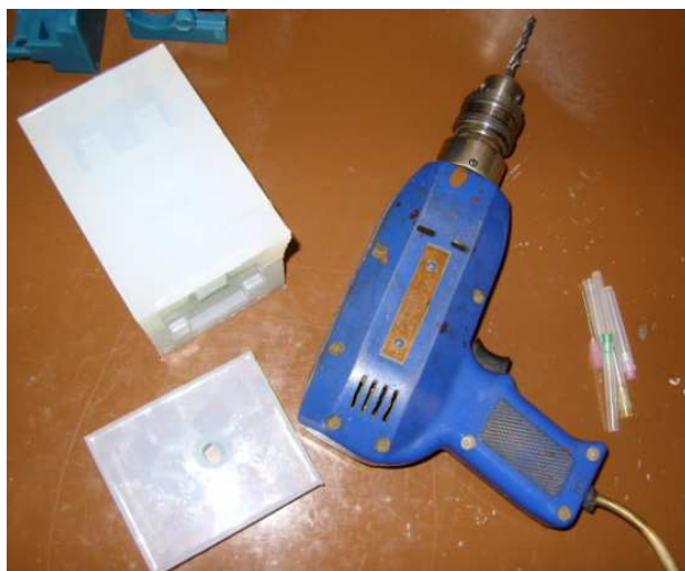
Obr. 2.2-17 Zhotovení průduchů do silikonové formy
