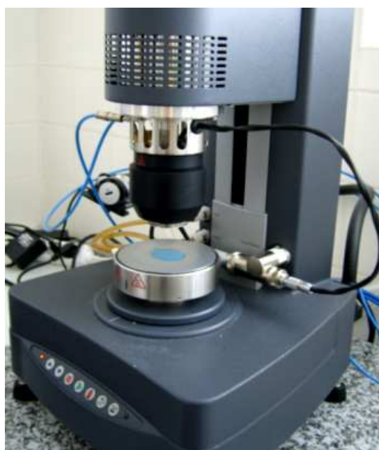
Obr. 2.4-33 Reometr AR-G2 s nadávkovaným vzorkem voskové směsi a schéma použité geometrie deska – deska [48]
