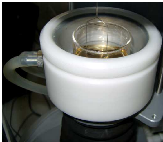
Obr.1.5-24 Metoda odtrhávání prstence [45]
