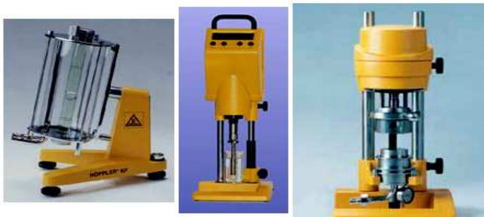
Obr.1.5-17 Kuličkový pádový, rotační a tlakový kapilárový viskozimetr [36]
