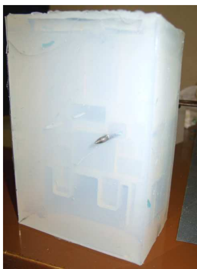
Obr. 2.2-18 Vytváření průfuků v místech kde hrozí poškození odlitku při vyjímání z formy
