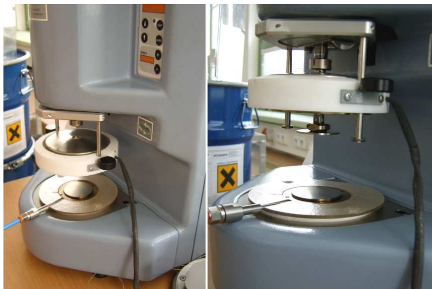
Obr. 2.4-29 Viskozimetr Bohlin Gemini 150, detail na použitou geometrii
