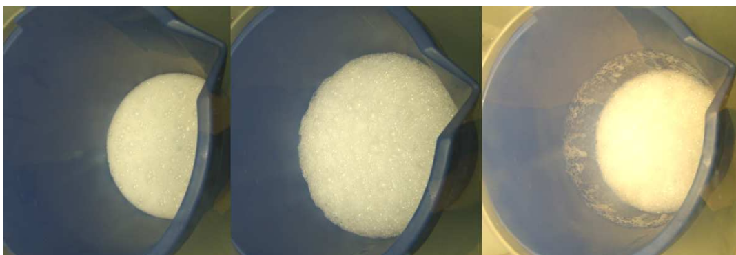
Obr. 2.2-8 Během vakuování dojde vlivem odplynování k nárůstu objemu a pak k jeho poklesu
