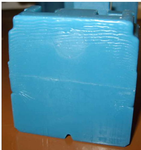
Obr. 2.2-19 Na dolní straně modelu jsou patrné studené spoje a nedolití
