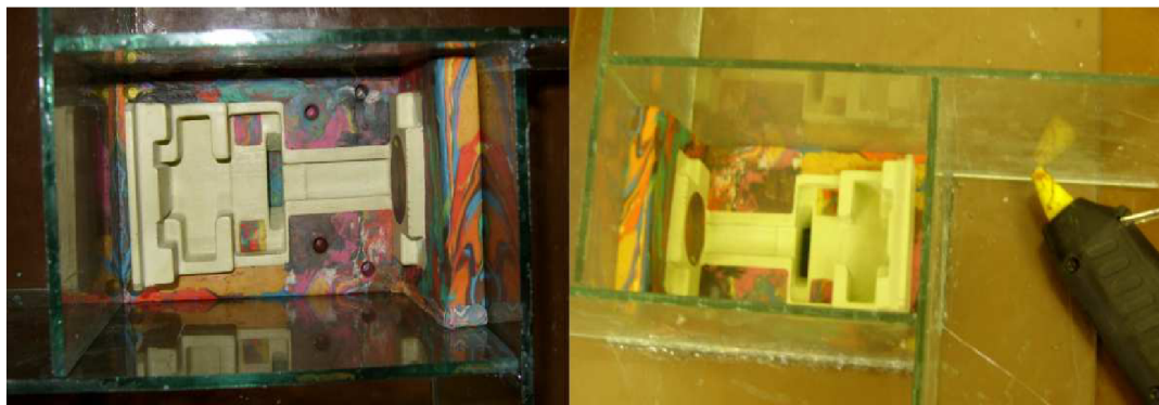
Obr. 2.2-7 Zaformovaný model připravený k odlití prvního dílu formy
