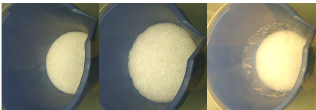
Obr. 2.2-8 Během vakuování dojde vlivem odplyňování k nárůstu objemu a pak k jeho poklesu
