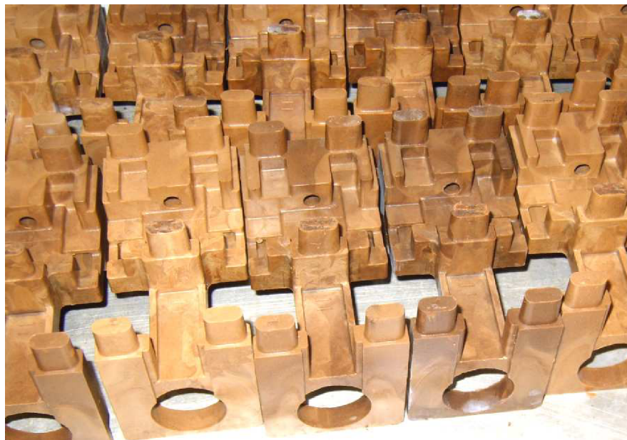
Obr.1.6-6 Při výrobě modelu 019 – C 002 CROWN CENTRE ve slévárně FIMES, byla použita vosková směs složená z Parafinu, Stearinu, Romoty a Ceresinu
