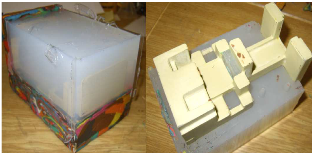
Obr. 2.2-10 Po odstranění skel a modelíny se provede očištění a odstranění výronků, lze provést i korekce tvaru formy seříznutím
