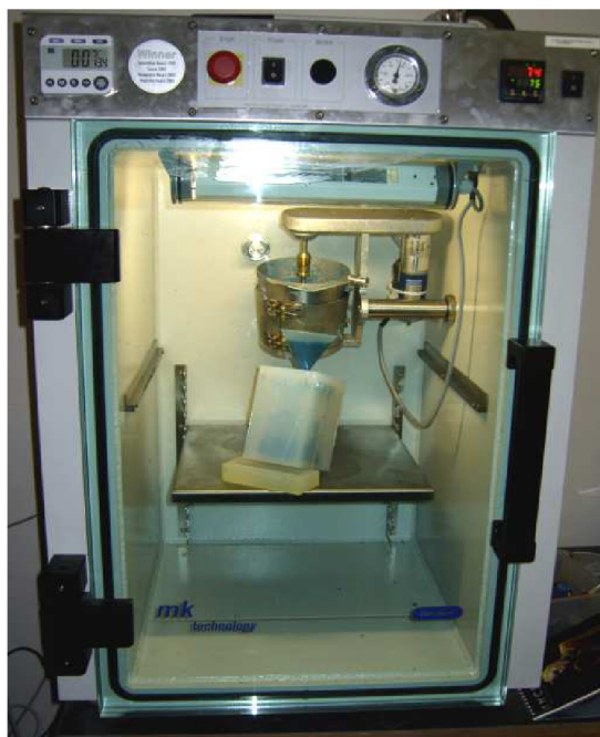
Obr. 2.2-15 Odlévání voskového odlitku ve vakuové komoře
