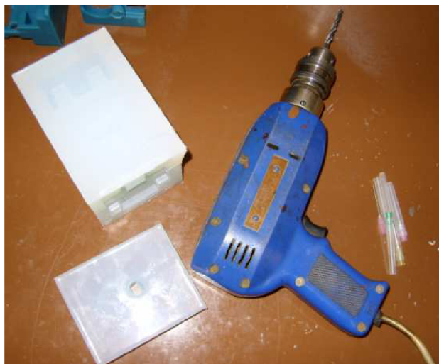
Obr. 2.2-17 Zhotovení průduchů do silikonové formy
