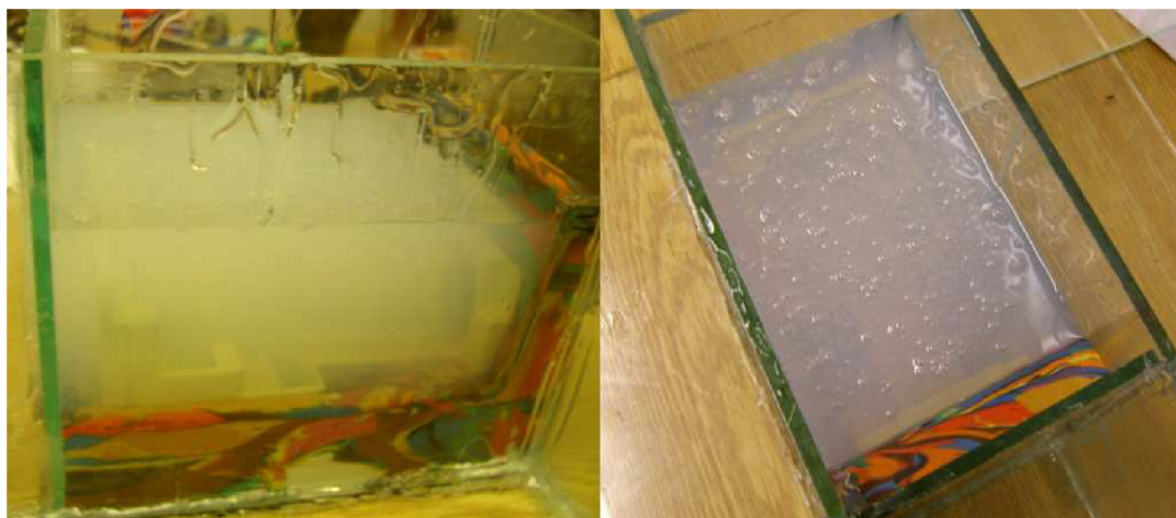
Obr. 2.2-9 Po odlití po nedokonalém vyvakuování dochází k vyplouvání značného množství vzduchových bublinek
