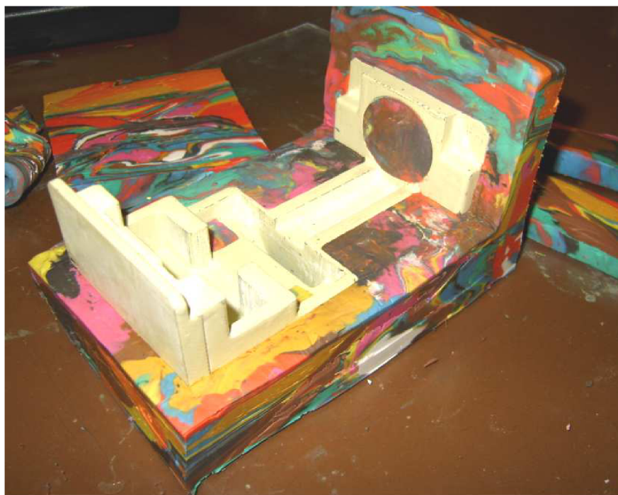
Obr. 2.3-6 Zaformovaný model pro výrobu první části silikonové formy
