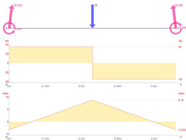
Obr. 6.10: Vykreslenie ohybového momentu s posúvajúcou silou vrchného prútu Stola č. 1 aplikáciou ForceEffect
