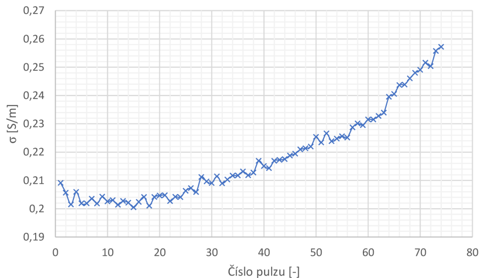
Obrázek 25 – Závislost měrné elektrické vodivosti na zvyšujícím se napětí s každým pulzem
