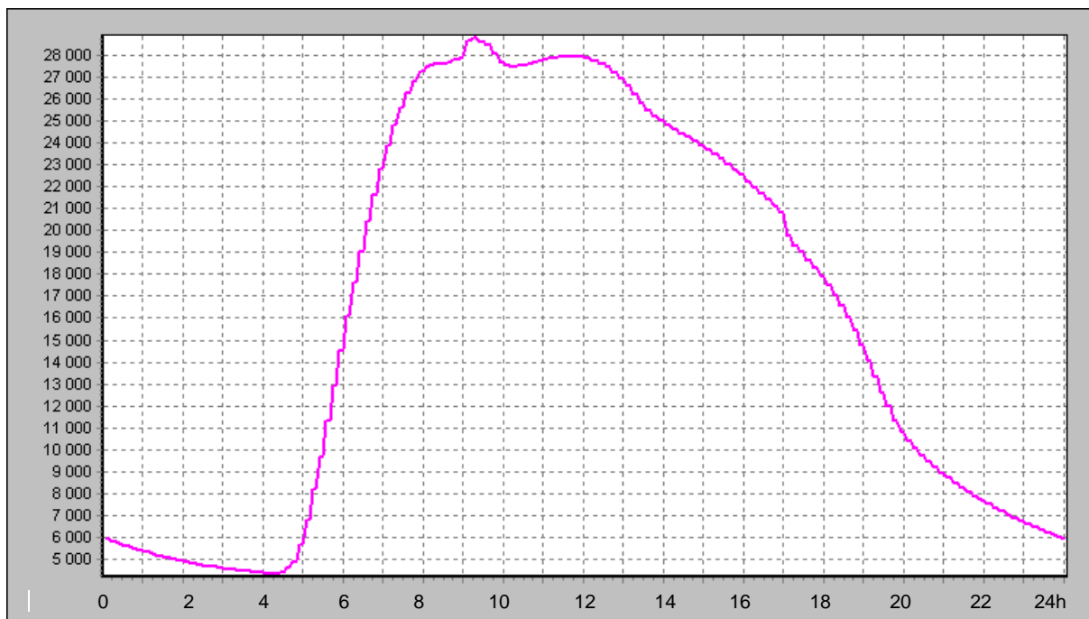
Graf 33: Tepelná zátěž 21.7. pro železobeton + EPS [W]
