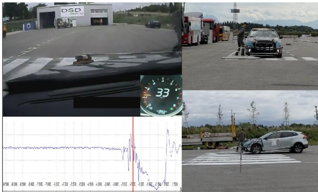
Obr. 103 Zrážka vozidla Volvo s figurínou - prípadová štúdia č.6. [60]
