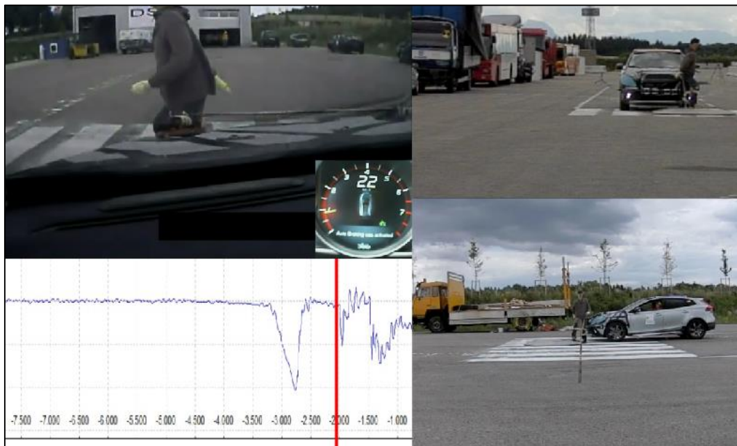
Obr. 113 Zrážka vozidla Volvo s figurínou - prípadová štúdia č.11. [60]
