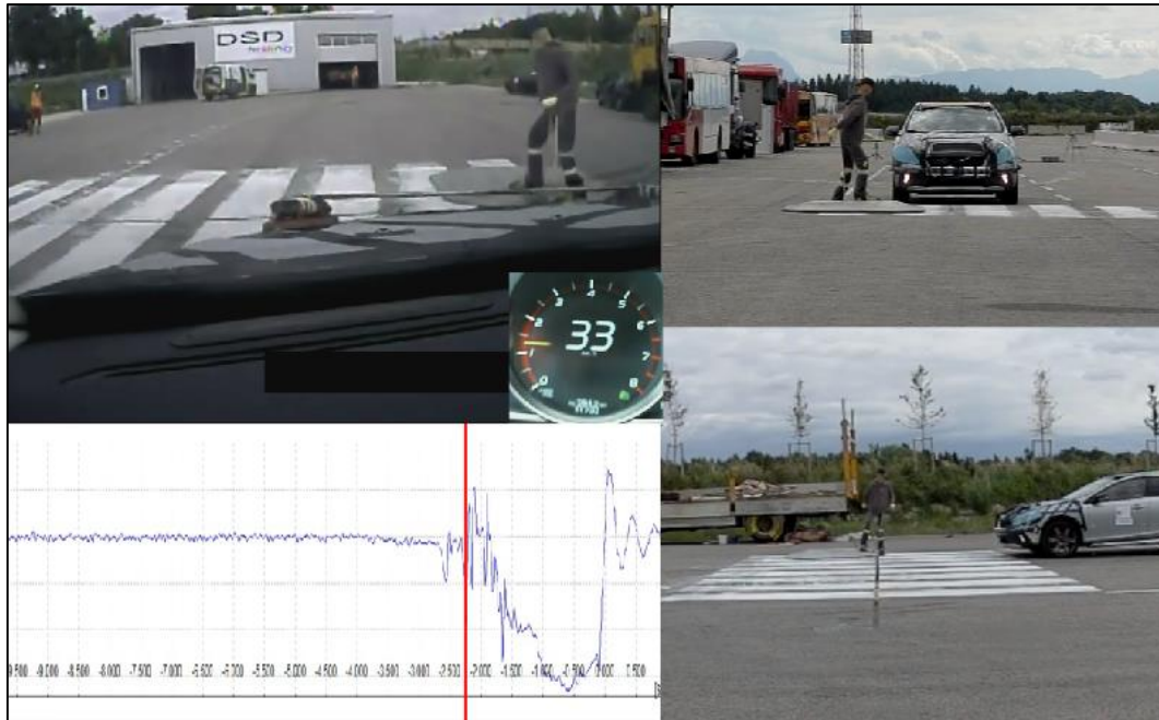
Obr. 102 Moment aktivácie autonómneho brzdzenia - prípadová štúdia č.6. [60]
