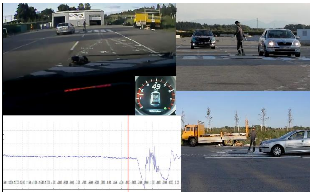
Obr. 96 Moment aktivácie akusticko-vizuálneho varovného signálu - prípadová štúdia č.4. [60]
