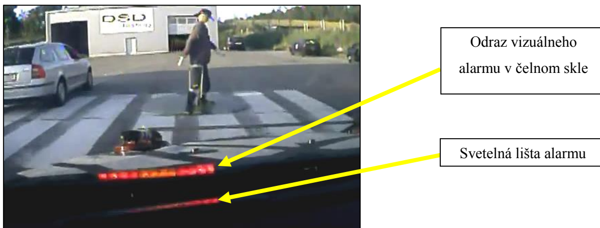
Obr. 83 Pohľad na rozsvietenú lištu alarmu a jej odraz v čelnom skle pri rozpoznaní chodca a následnom varovaní vodiča.[60]
