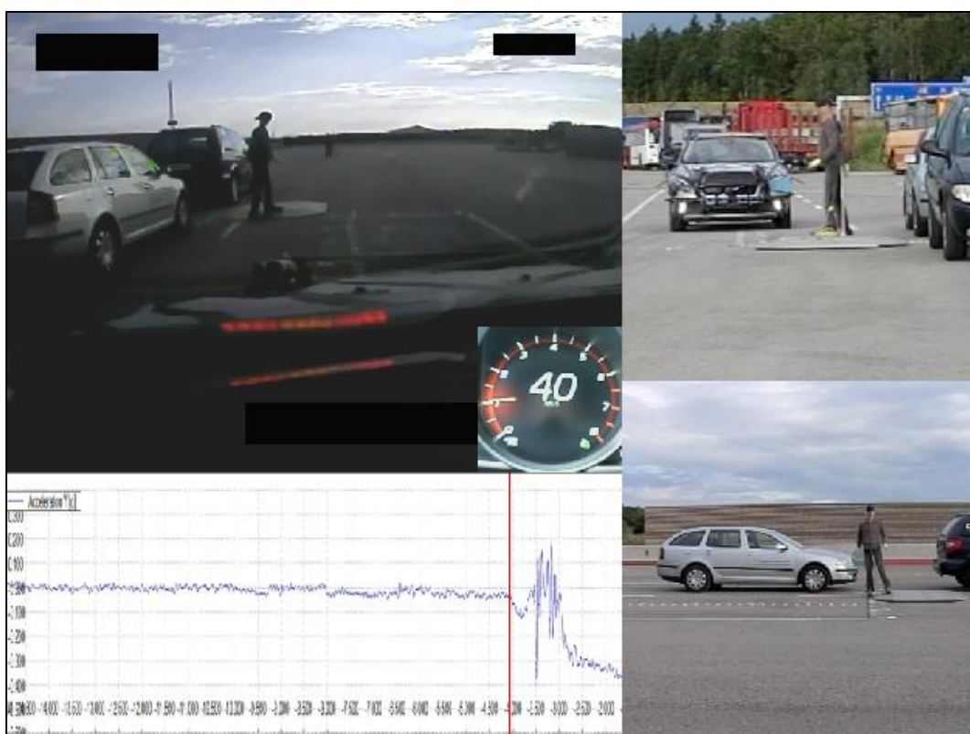
Obr. 117 Aktivácia alarmu a nábeh brzdného účinku vozidla Volvo - prípadová štúdia č.16. [60]
