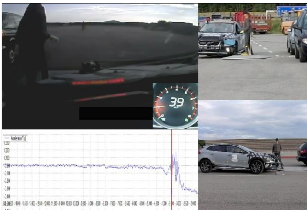
Obr. 118 Úspešný vyhýbací manéver vodiča a zabránenie zrážky s chodcom - prípadová štúdia č.16. [60]
