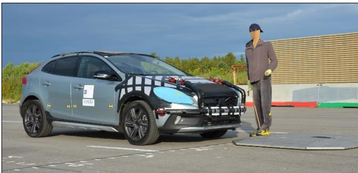
Obr. 67 Testovacie auto, figurína a autonómna plošina – UFO. [60]
