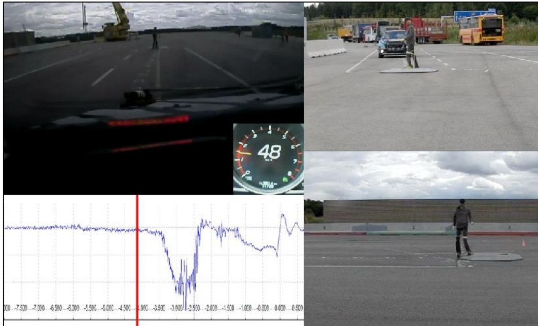
Obr. 119 Moment aktivácie akusticko-vizuálneho varovného signálu - prípadová štúdia č.18. [60]
