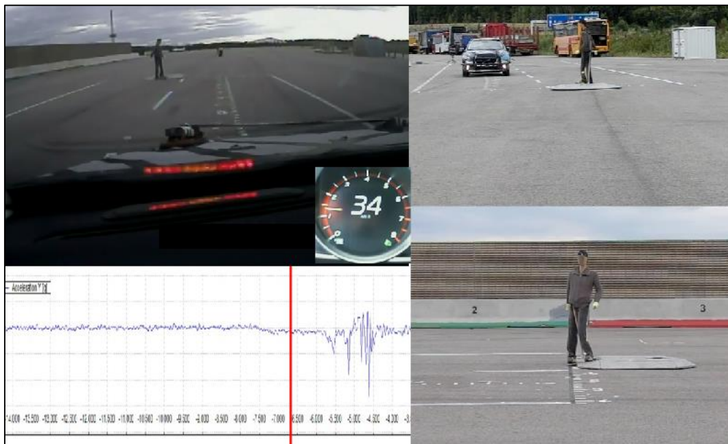
Obr. 99 Moment aktivácie akusticko-vizuálneho varovného signálu - prípadová štúdia č.5. [60]
