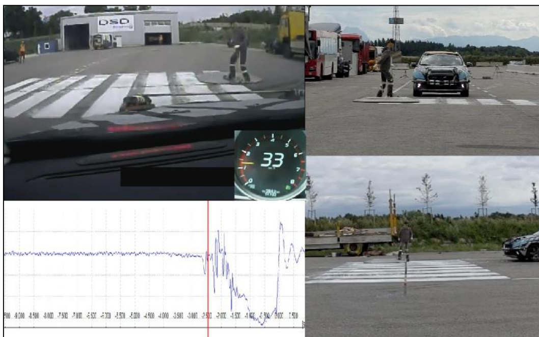
Obr. 101 Moment aktivácie akusticko-vizuálneho varovného signálu - prípadová štúdia č.6. [60]
