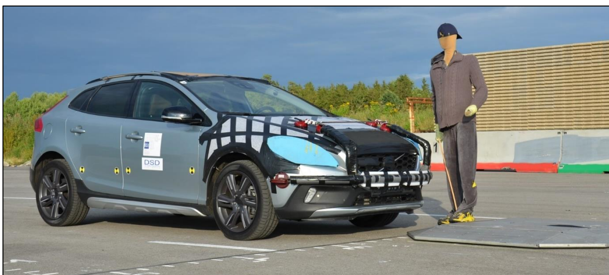
Obr. 77 Testovacie vozidlo, figurína a autonómna plošina UFO. [60]
