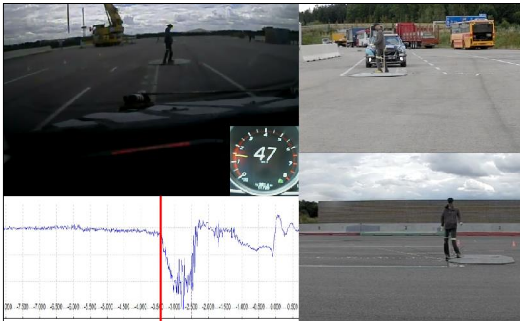
Obr. 120 Moment aktivácie autonómneho brzdenia - prípadová štúdia č.18. [60]
