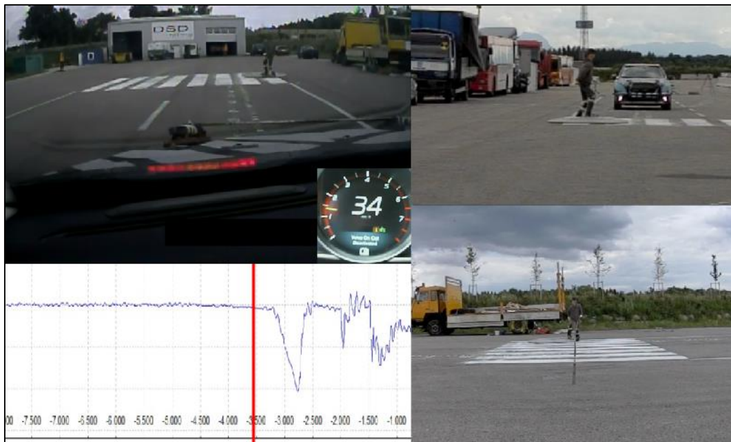
Obr. 110 Moment aktivácie akusticko-vizuálneho varovného signálu - prípadová štúdia č.11. [60]
