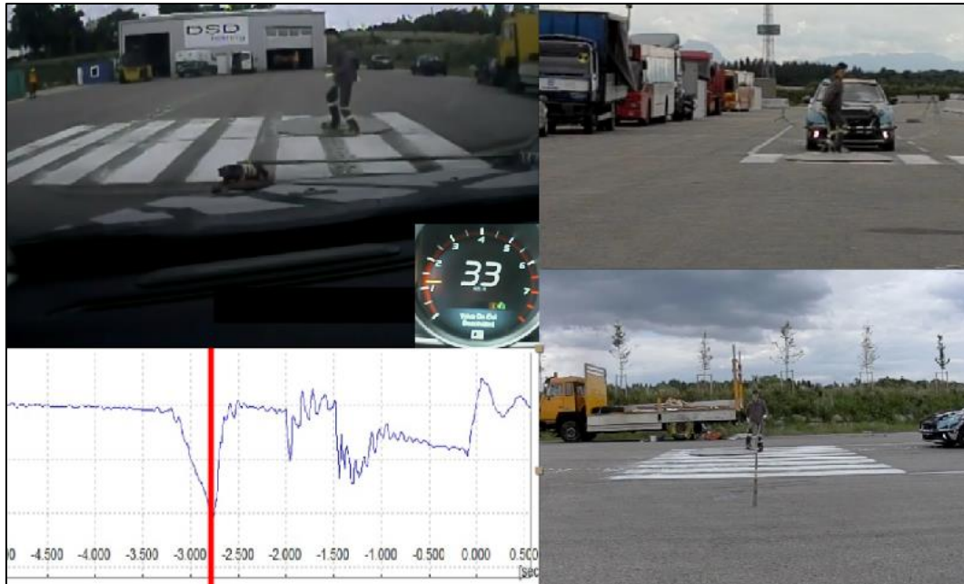
Obr. 112 Vypnutie autonómneho brzdzenia - prípadová štúdia č.11. [60]
