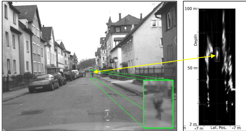
Obr. 28 Prevod obrazu do karteziánskeho súradnicového systému. [30]
