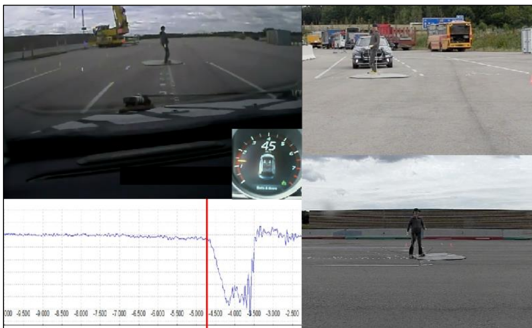
Obr. 115 Moment aktivácie autonómneho brzdenia - prípadová štúdia č.14. [60]
