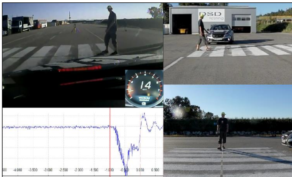
Obr. 93 Moment aktivácie akusticko-vizuálneho varovného signálu - prípadová štúdia č.3. [60]
