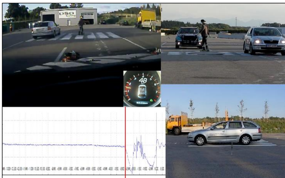
Obr. 97 Moment aktivácie autonómneho brzdenia - prípadová štúdia č.4. [60]
