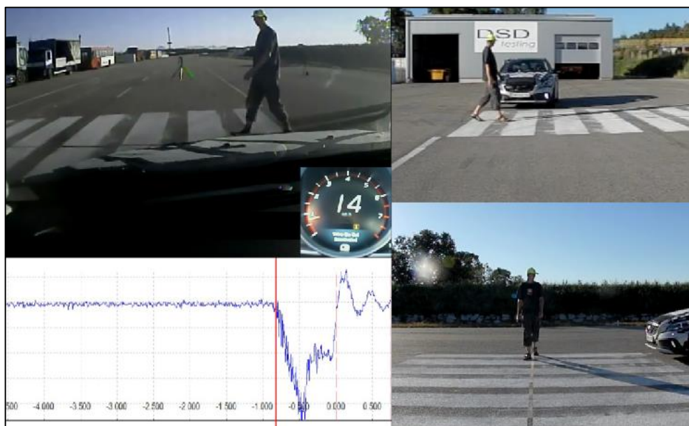
Obr. 94 Moment aktivácie autonómneho brzdenia - prípadová štúdia č.3. [60]
