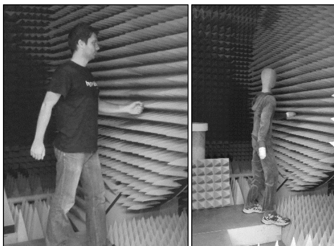
Obr. 72 Poloha figuranta a figuríny v miestnosti pri bočnom meraní. [60]
