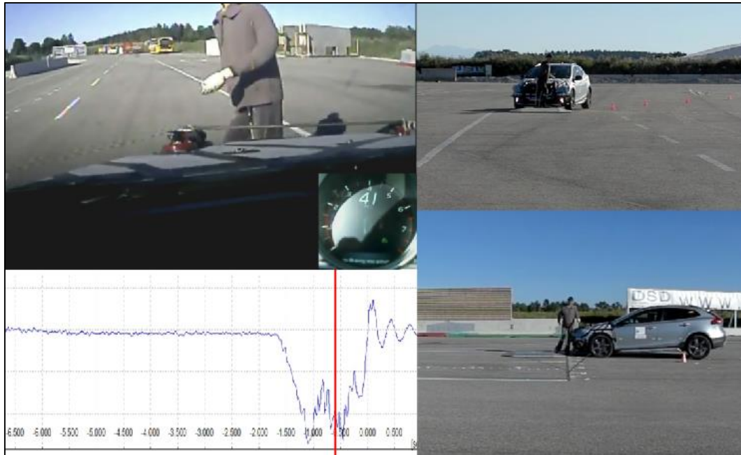
Obr. 106 Zrážka vozidla Volvo s figurínou - prípadová štúdia č.7. [60]
