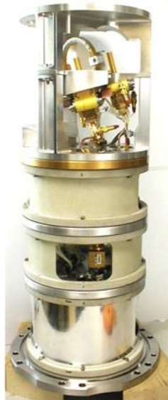
Obrázek 12 – Přijímač signálu pro Band 7 s kryostatem
