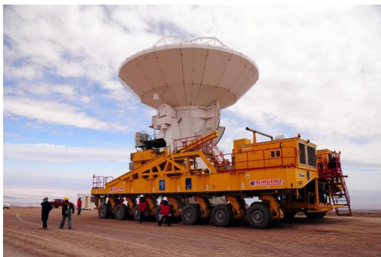
Obrázek 8 – Transportér Otto přemísťující jednu z antén
