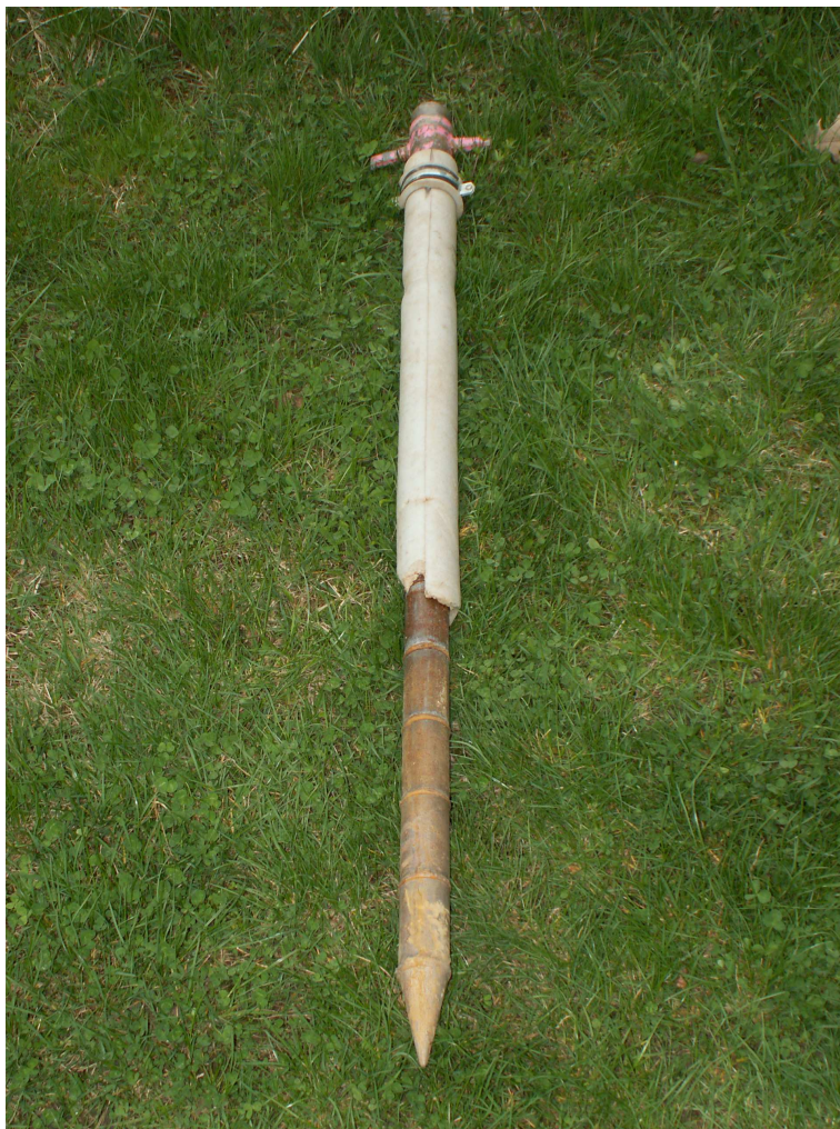
Příloha 1: Sonda potřebná k odběru sedimentu prostřednictvím metody „freeze-core“.
