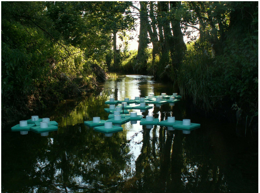
Příloha 6: Rozmístění plovoucích komor v terénu.
