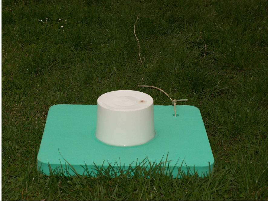
Příloha 5: Plovoucí komora pro měření emisí metanu z hladiny toku.
