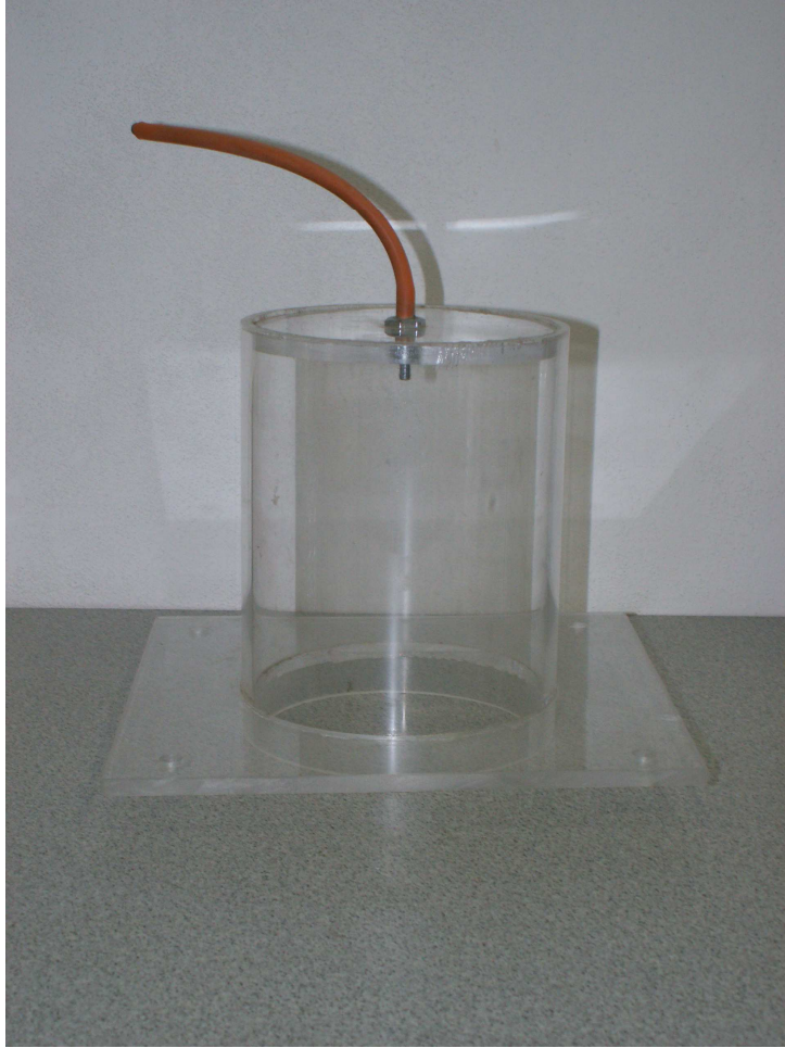
Příloha 4: Bentická komora pro měření difuze metanu ze sedimentu.
