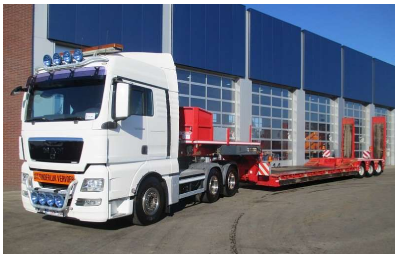
Obrázek č. 26 - Tahač MAN TGX 33.500 6x4 s podvalníkem Goldhofer STN L3 38/80 [21]
