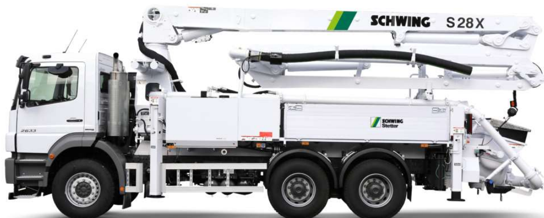
Obrázek č. 32 - Autočerpadlo Schwing S 28 SX [27]
