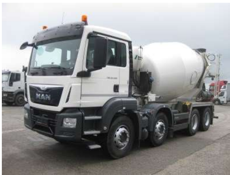
Obrázek č. 31 - Autodomíchávač MAN TGS 32.400 8X4 BB [26]
