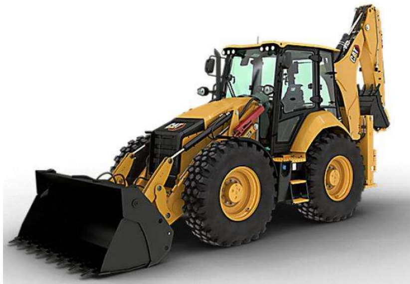
Obrázek č. 20 – Rypadlo-nakladač CAT 444 [15]
