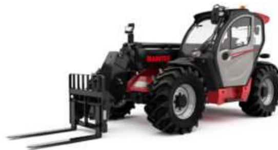
Obrázek č. 38 - Teleskopický manipulátor Manitou MLT 940-140 V+ [34]
