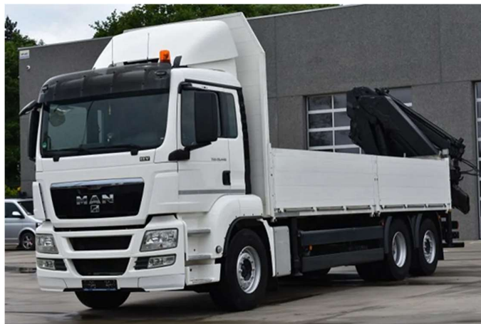
Obrázek č. 30 - Valník s hydraulickou rukou MAN TGS 26.440 [25]
