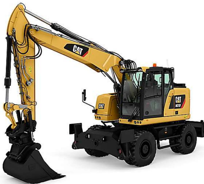
Obrázek č. 18 – Kolové rypadlo CAT M315F [13]
