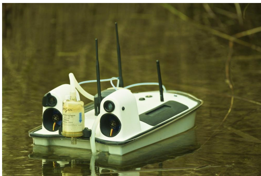
Obrázek 4: Vodní dron jako prostředek pro sbírání vzorku pro analýzu DNA. Zdroj: Hoffmann a kol., 2016. Autoři fotografie: Alice Valentini a Tony Dejean.
