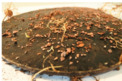
Obrázek č. 11: Demontrace průběhu testování odolnosti proti prorůstání kořenů na BOKU (zdroj: autor, 2016)
